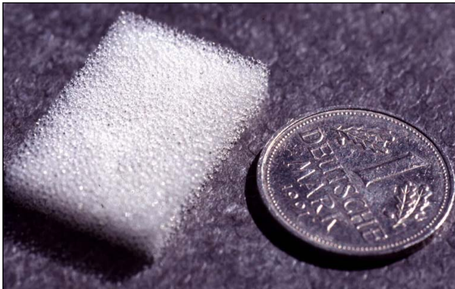
Abbildung 8: Zur Sekretsammlung verwendete Schaumstoffsammler (offenporiger Polyurethanschaumstoff, 35 \text{ kg/m}^3 , 28 \times 18 \times 6 \text{ mm} ). Zum Größenvergleich: Liebhaberstück.
