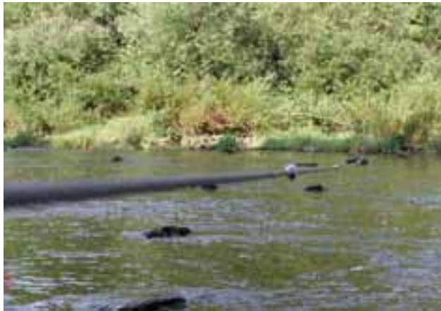
Abbildung B 13: Kennzeichnung eines zu vermessenden Querprofils mit einer gespannten Peilleine
