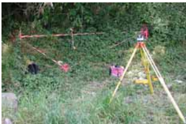
Abbildung B 14: Nivelliergerät und eingerichtete Versicherungspunkte, die nach der genauen Einmessung zur Reproduzierbarkeit der Profillage herangezogen werden können
