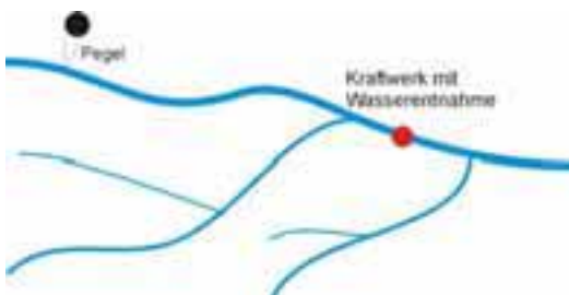
Abbildung 4: Lage der Wasserentnahme in weiterer Entfernung von einem Pegel
