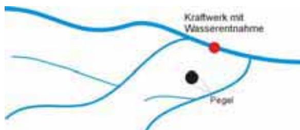
Abbildung 7: Kein Pegel im Bereich der Wasserentnahme vorhanden
