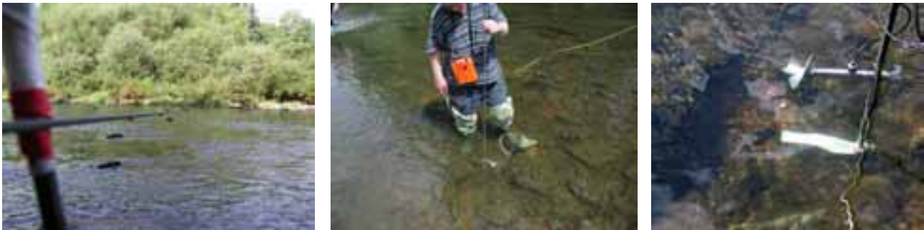
Abbildung 9.14: Arbeiten im Abflussmessprofil. Links: Profilmarkierung mittels eines gespannten Stahlseiles mit Markierungen für einzelne Messlotrechten. Mitte: Messflügel und Zählgerät im Einsatz. Rechts: Messflügel. Aufnahmen: 24.7.01.
