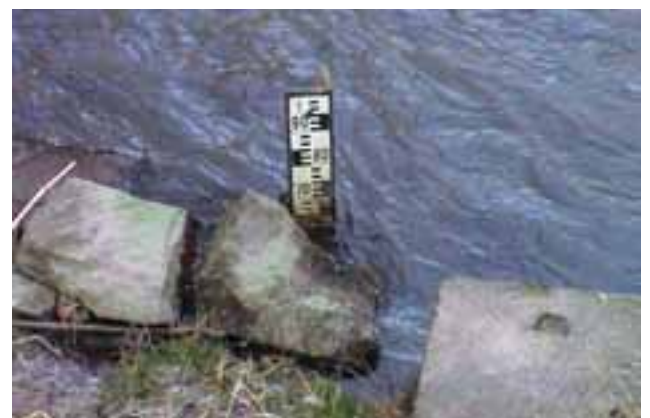
Abbildung B 15: Temporärer Kontrollpegel mit Messlatte
