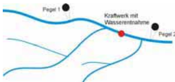
Abbildung 5: Lage der Wasserentnahme zwischen zwei Pegelanlagen
