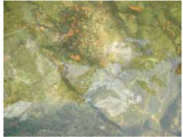
Abbildung 9.18: Deckschichtbildung im Bereich der pessimalen Schnelle. Links: Stabile Deckschicht aus sehr groben Substrat. Rechts: Nach Entfernen der Deckschicht erkennt man das feinere Substrat. Aufnahme: 24.07.01
