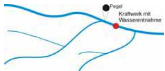
Abbildung 3: Lage der Wasserentnahme in unmittelbarer Nähe zu einer Pegelanlage
