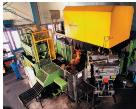
Aluminium-Druckgießmaschine bei der Herstellung von Hochpräzisionsteilen
