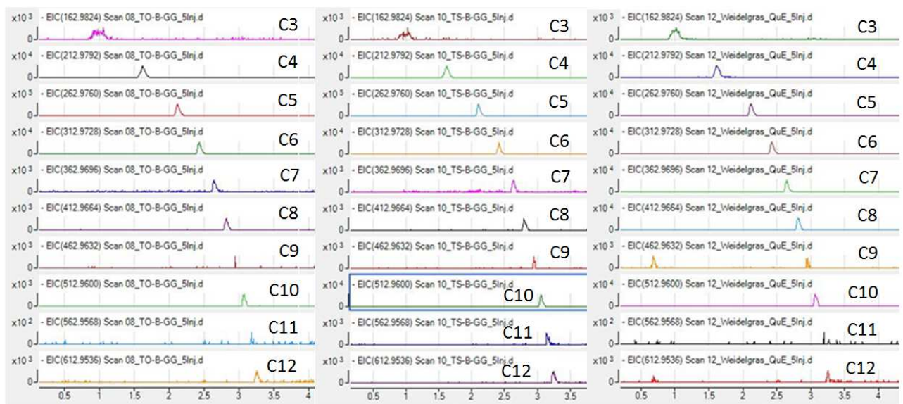
Abbildung 60: Chromatogramme der extrahierten Ionen (EIC) für Perfluorcarbonsäuren (PFCA) in den Pflanzenextrakten von Topinambur (E-TO-B-GG; E-TS-B-GG; links und Mitte) und Weidelgras (E-WG-B-GG; rechts) von belastetem Boden.
