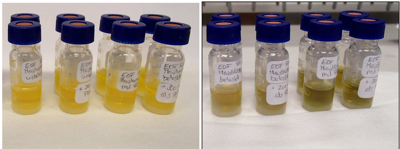
Abbildung 11: Messfertige Extrakte von Maiskorn (links) und Maisblättern (rechts) nach Extraktion und Clean-up-Schritt.
