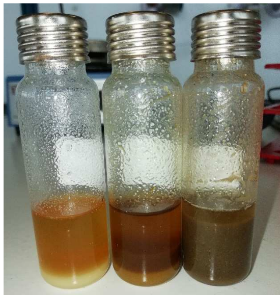
Abbildung A4: Schwefelsäureaufschlüsse von jeweils 0,05 g Maiskorn (links), Tobinambur (Mitte) und Maisblatt (rechts) nach Neutralisation mit Natronlauge.
