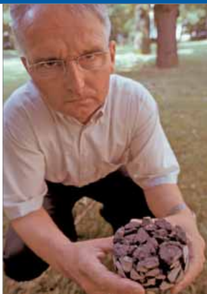
Dr. Andreas Bieberstein zeigt einen Bohrkern aus porösem und durchwurzelbarem Mastix-Schotter.
