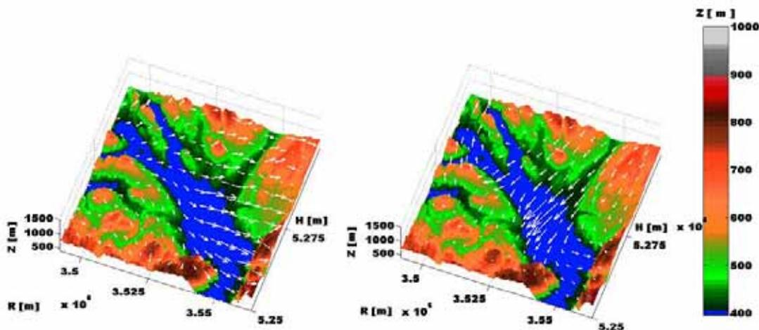
Abbildung 4: Hauptwindrichtungen über dem Bodensee. Dargestellt ist das Windfeld in ca. 10 m Höhe über Grund. Links: Westwindlage mit max. Windgeschwindigkeit von 6 m/s Rechts: Nord-Ost-Windlage mit max. Windgeschwindigkeit von 3 m/s, Koordinaten in Gauß-Krüger.
