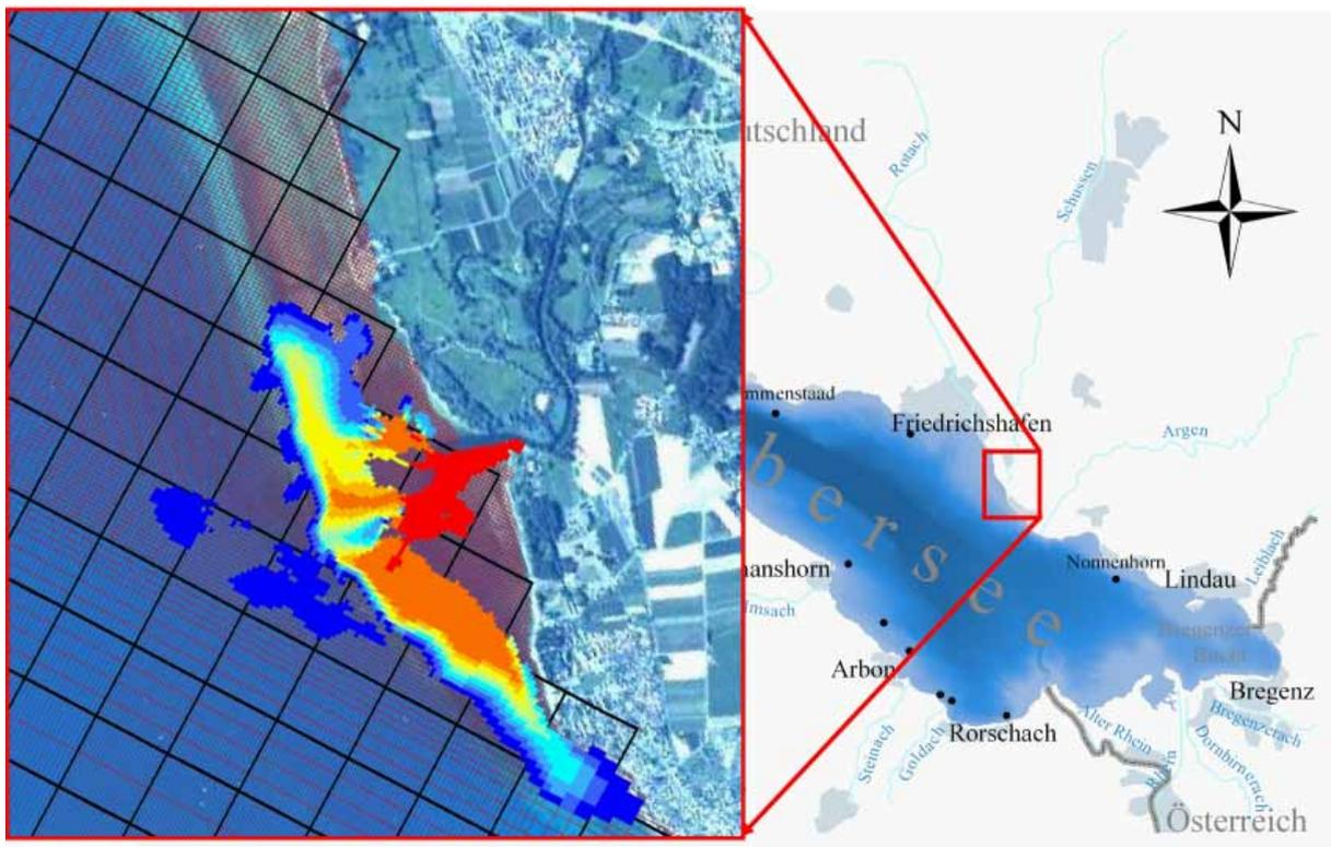
**Abbildung 3: Modellnetz des großräumigen Modells (schwarz) und Lokalmodell der Schussen mit Ausbreitung der Flusswasserfahne**
