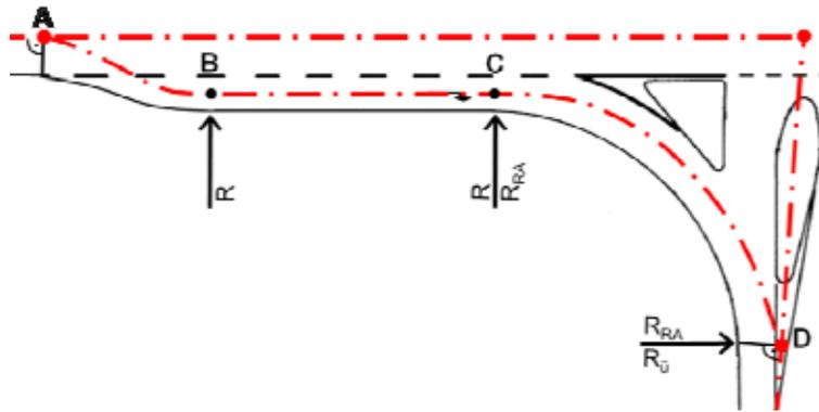
**Abbildung 4: Konstruktion eines Astes im plangeichen Knotenpunkt (Rechtsabbiegestreifen)**
