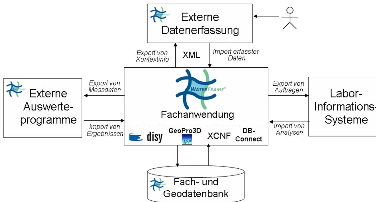
Abbildung 2: Grundstruktur von WaterFrame®-Systemen
