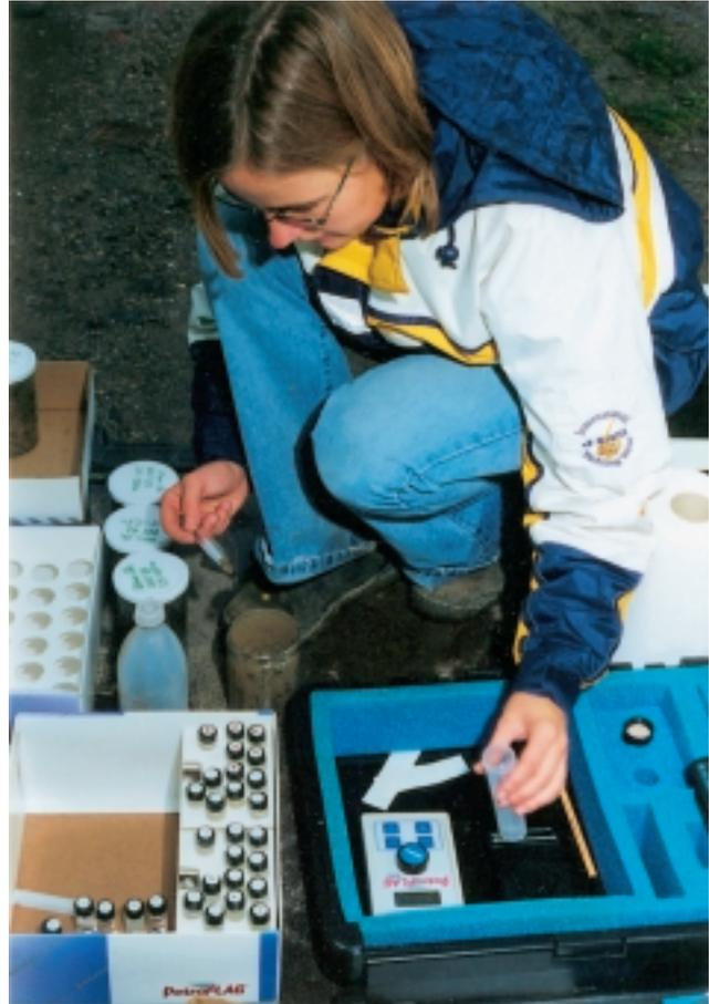
Abb. 1: Einsatz eines feldfähigen Geräts zur Bestimmung von Mineralölkohlenwasserstoffen im Boden
