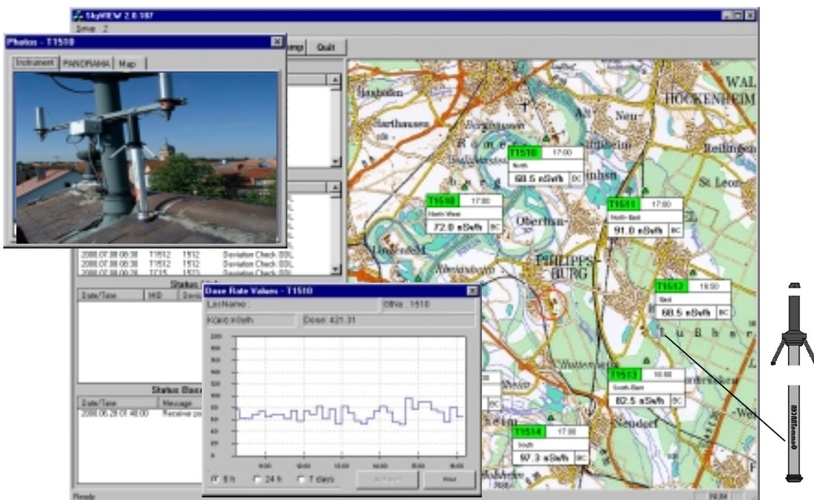
Abb. 3: Displaydarstellung der Datenzentrale
