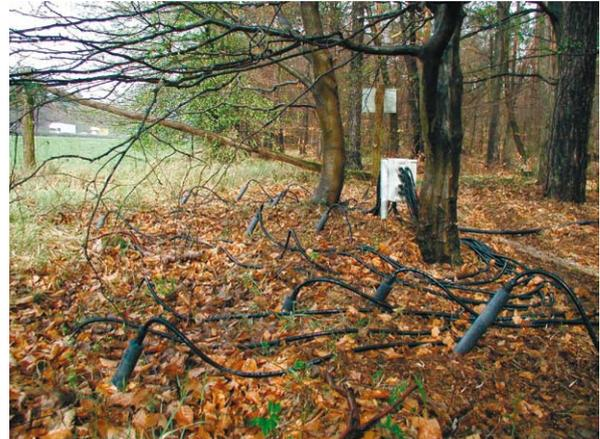
**FDR-Sonden im Schrägeinbauverfahren an der Messstelle Forst**
