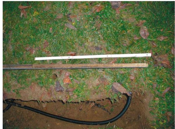
**TDR-Sonde im Grabeneinbauverfahren an der Messstelle Vellberg-Klein-Aldorf**
