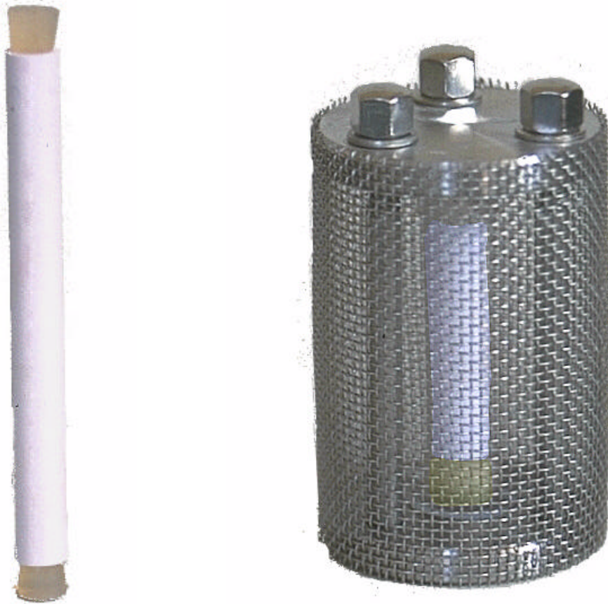
Abb. A.1: Keramikdosimeter Vollansicht Länge 10 cm Durchmesser 1 cm (links) und im Edelstahl-Schutzkäfig bzw. Abstandhalter, um eine optimale Anströmung im Grundwasser (Multilevel-Packer) zu gewährleisten (rechts).
