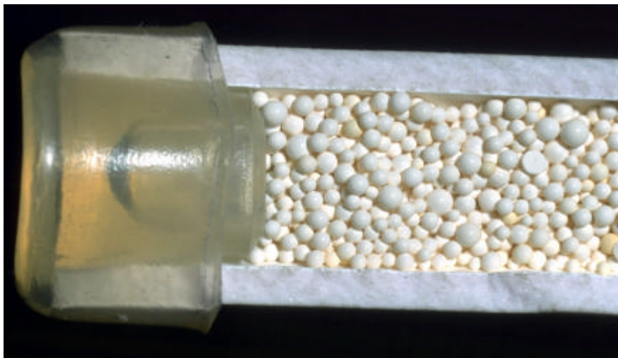
Abb. A.2: Schnitt durch Keramikdosimeter mit IRA-743 Adsorbermaterial Durchmesser 1 cm.
