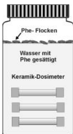
Abb. 3.3: Versuchsanordnung: Aufbau der Batchversuche (z.B. Phe) zur Kalibrierung der Keramikdosimeter (PIEPENBRINK, 1998).
