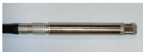
Bild 33: P-U-Sonde von Microflown
