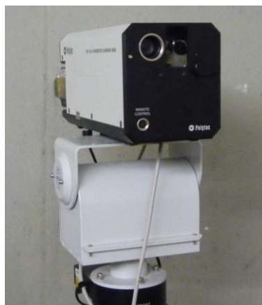
Bild 27: Foto des Scanning-Laser-Vibrometers.
