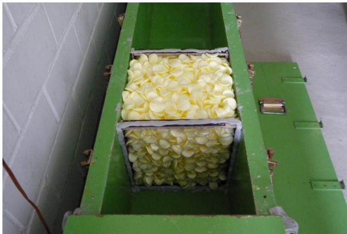
Bild D 1: Gitterbox mit Verpackungschips im Kundt'schen Rohr des IBP
