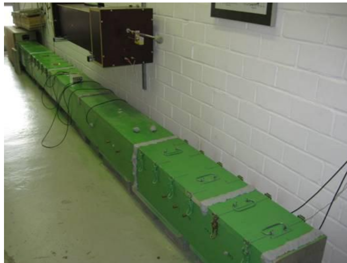
Bild B 3: Foto des Kundt'schen Rohrs im Labor des IBP.
