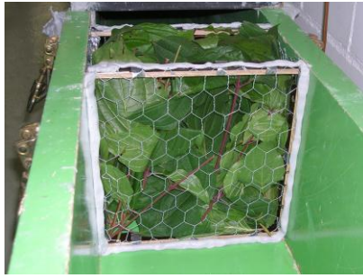
Bild 17: Gitterbox gefüllt mit Rotem Hartriegel im Kundt'schen Rohr (Füllgewicht 300 g) bei der Messung der Einfügungsdämmung.
