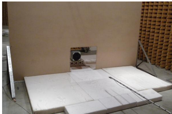
Bild 5: Foto des Messaufbaus im Halb-Freifeldraums des IBP.
