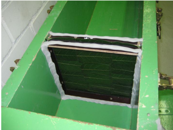
Bild B 4: Foto der Blattfläche des Roten Hartriegels im Kundt'schen Rohr bei Einbau zur Messung der Schalldämmung.
