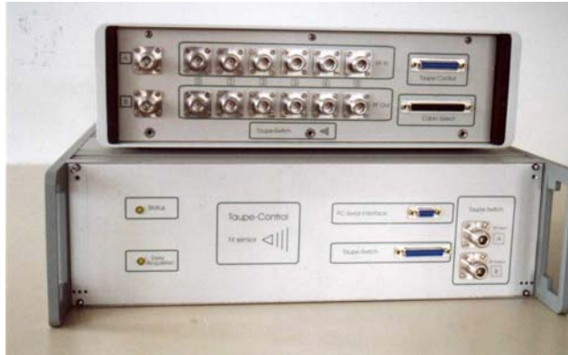
Bild 23: Messgerät zur Messung im Frequenzbereich (FDR)
