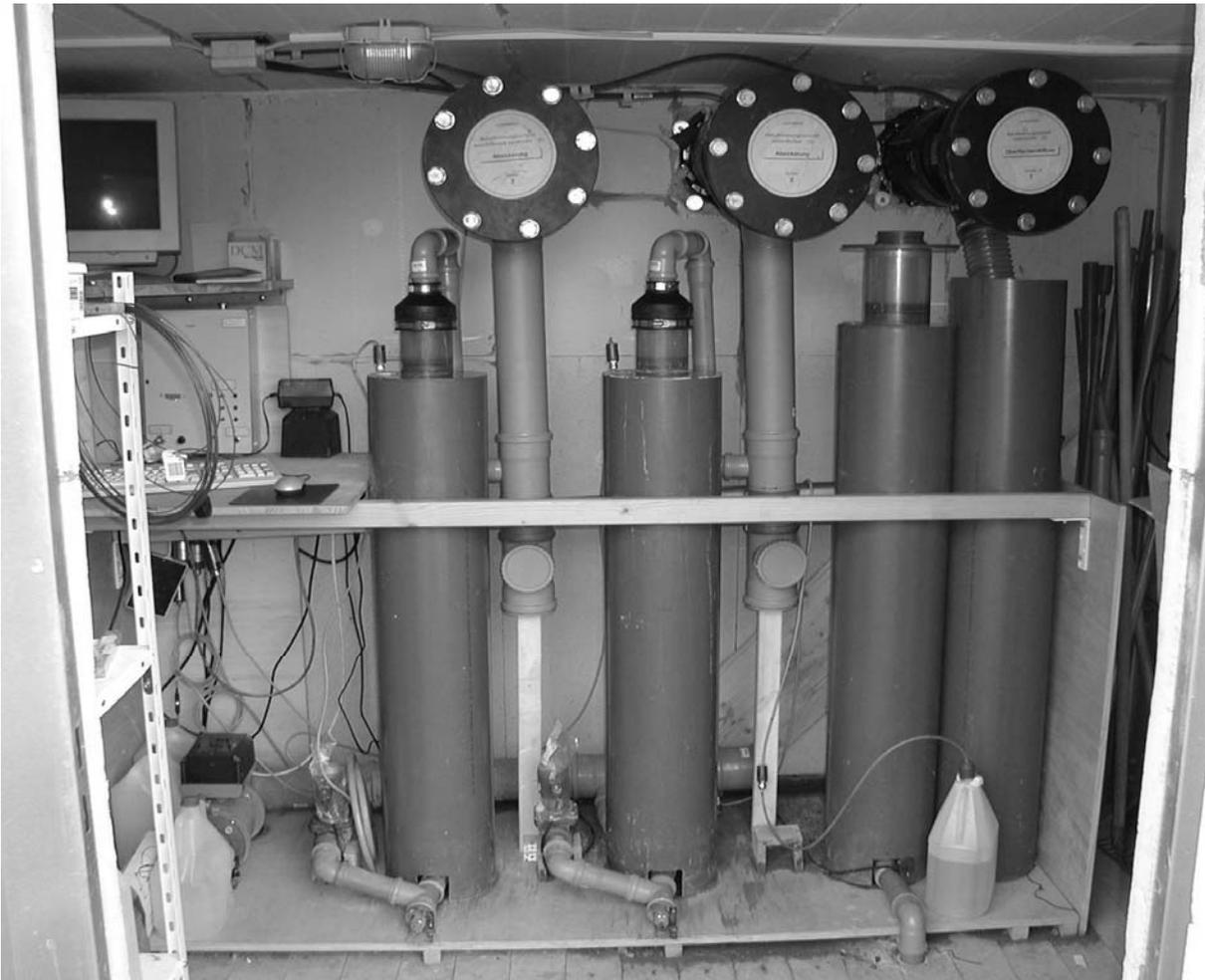
Abbildung 3-4: Anlage zur Messung der Abflüsse aus den Lysimeterfeldern
