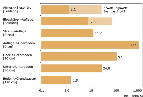
Medienübergreifende Bleifrachten an der Intensiv-Messstelle Forst im Messjahr 2002 (Messbetrieb und Auswertung: UMEG; Datengrundlage: UMEG & LfU)
