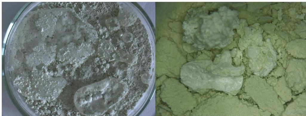
**Abb. 22: Auflichtmikroskopische Aufnahme der Probe PMT-09 nach der Behandlung mit Wasser. Hier sieht man direkt eine Rekristallisation von  $\text{CaCl}_2$  außerhalb der Probe**
