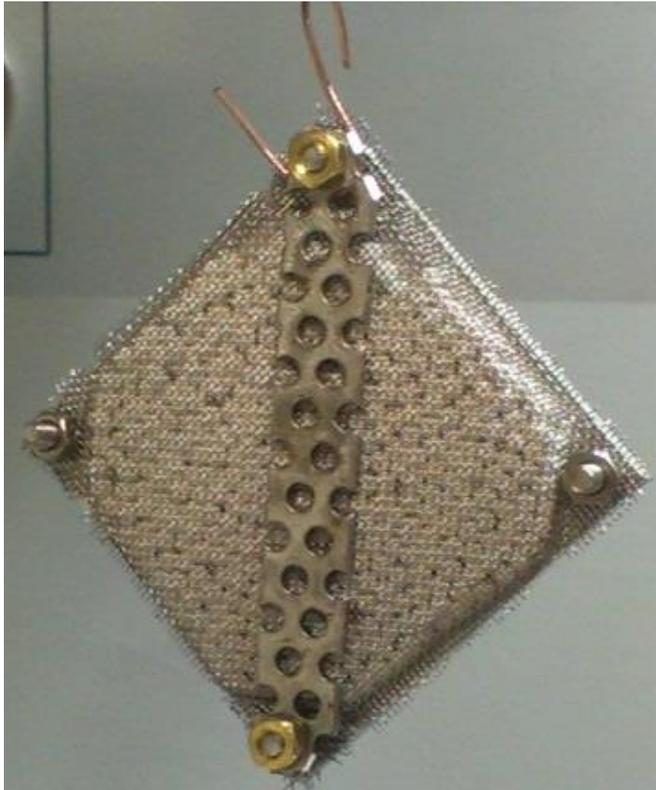
**Abb. 08: Probenhalter für Granulate zur Verwendung in der geschlossenen Zyklierungsanlage.**
