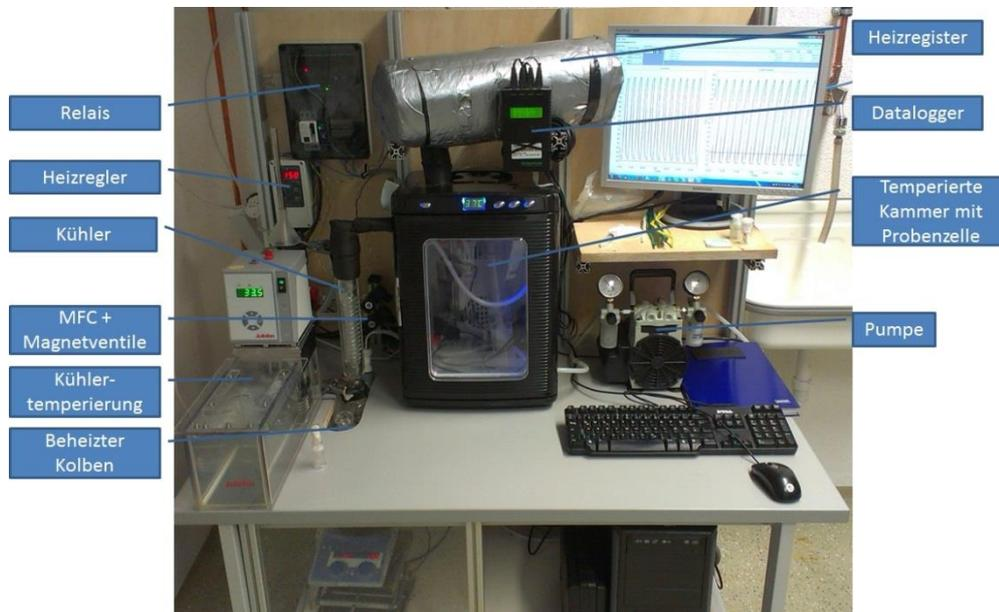
**Abb. 03: Aufbau des Pulverzyklenteststandes**
