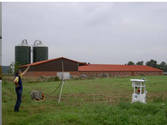
Abb. 4.2: Betriebsgelände mit (a.) Scanner des Lidar-Systems (Blickrichtung Süd, Entfernung 500 m) bzw. (b.) Probenahmegeräten für in-situ-Aerosolmessungen (Impaktor auf Stativ montiert, kombiniertes Filter- und Denudersammelgerät am Boden betrieben) im Vordergrund (Blickrichtung Nordost, Entfernung 150 m) bei Mettingen, Westfalen. In (b.) ist der Stall rechts im Bild.
