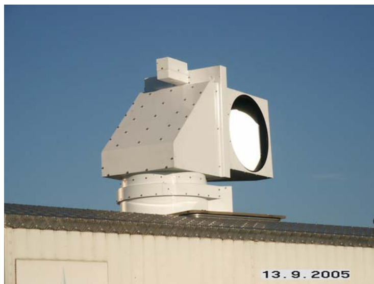
Abb. 2.3: Scanner des IPM Lidar-Systems während einer Messung
