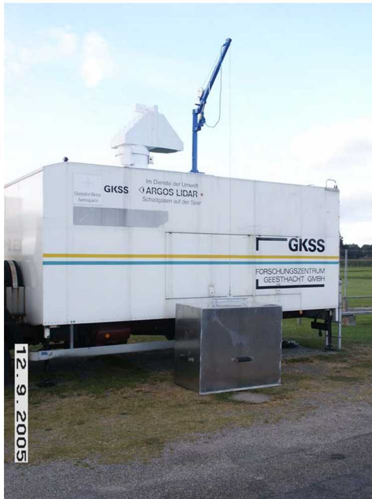
Abb. 2.8: Scanner, Abdeckhaube und demontierbarer Kran
