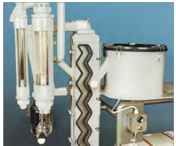
Abb. 4: Im Zickzacksichter wird in Schwer- und Leichtfraktion getrennt.
