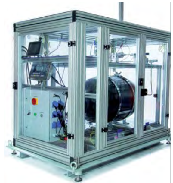
Der Teststand für die Referenzmessungen mit seinem 100-Liter-Wasserstofftank
