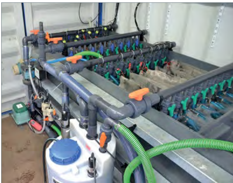
Versuchsanlage für die Nutzung von Bio-Brennstoffzellen im Abwasser Bild: CUTEC
