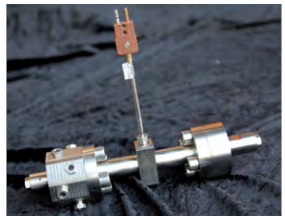
Präzisionsarbeit: Düse zur Messung des Wasserstoff-Durchflusses, hier ohne die Sensorik
