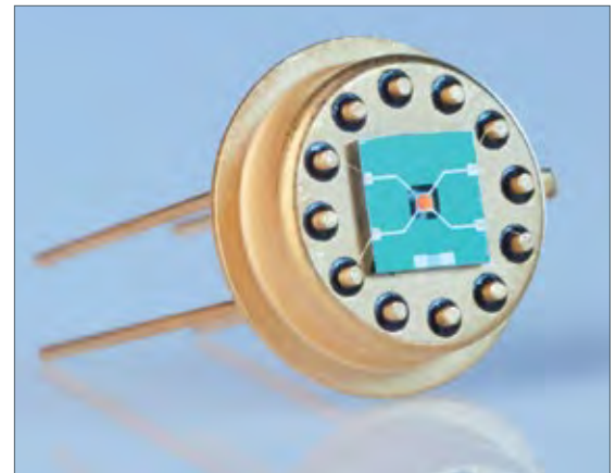
Vier mal vier Millimeter misst der am Fraunhofer IPM konstruierte Sensor.
