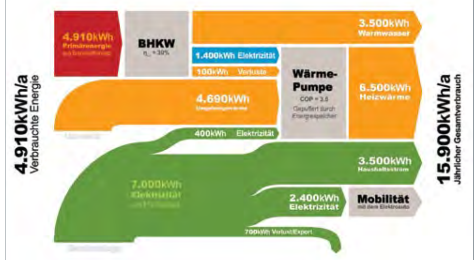
Schema des Energieverbrauchs beim Einsatz herkömmlicher Technik mit Gastherme und Mobilität mit Verbrennungsmotor (oben) im Vergleich zum Energieverbrauch beim Einsatz einer TH-E-Box in Verbindung mit Elektromobilität (unten): 4.910 statt 21.500 kWh pro Jahr.
