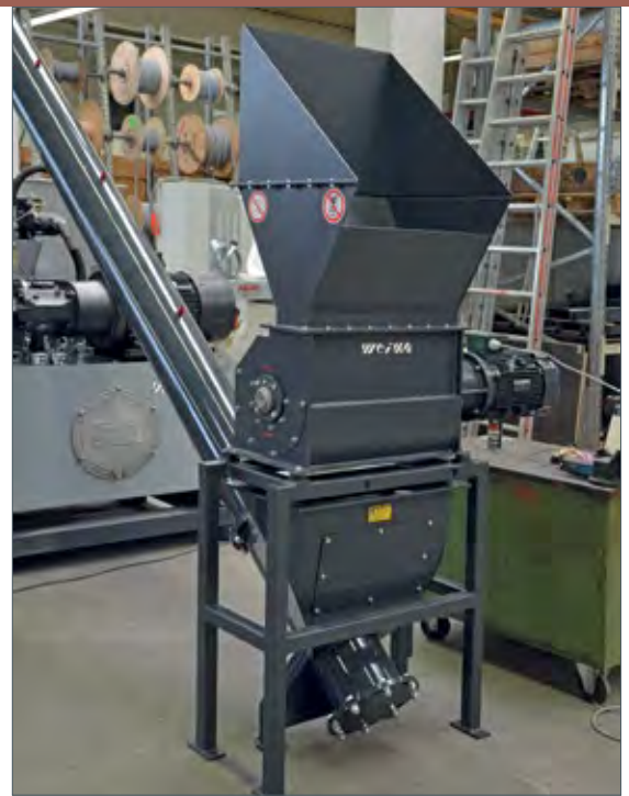
Abb. 3: Hammermühle zur Zerkleinerung
