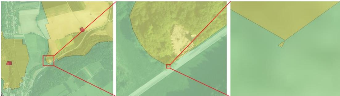
**Abbildung 1: Optisch kaum wahrnehmbarer Geometriefehler**
