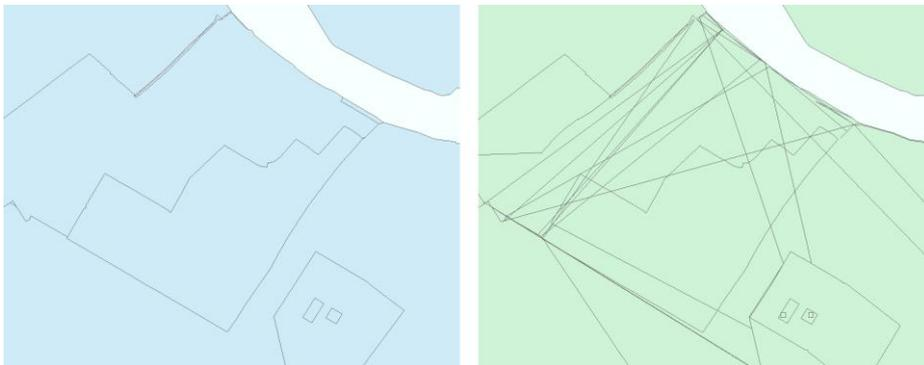
**Abbildung 83: Korrupte Geometrien, die bei der Korrektur mit Löchern entstehen (rechts) im Vergleich zu richtig korrigierten Geometrien (links)**
