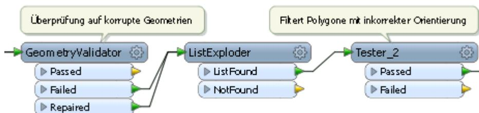
Abbildung 50: Prüfung auf falsch orientierte Polygone Im GeometryValidator
