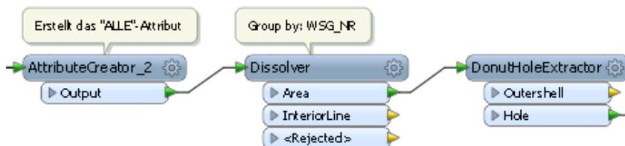
Abbildung 71: Prüfung auf Lücken zwischen Polygonen
