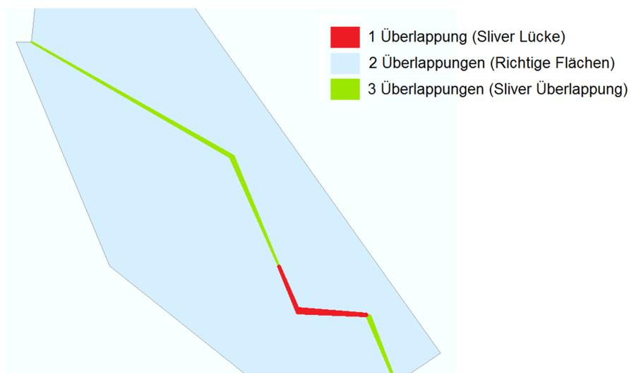
Abbildung 72: Sliver Polygone, die durch die Anzahl der Überlagerungen bestimmt wurden
