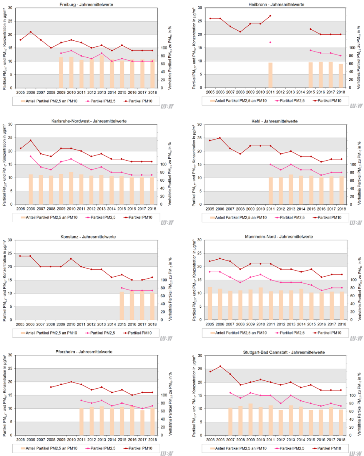
Abbildung 5.2-1: Entwicklung der Immissionsbelastung durch Partikel \text{PM}_{2.5} und Partikel \text{PM}_{10} (in \mu\text{g}/\text{m}^3 ) sowie des Verhältnisses beider Partikelfractionen zueinander (in Prozent); Jahresmittelwerte 2005 bis 2018 (soweit verfügbar); hier an den städtischen Hintergrundmessstationen Freiburg, Heilbronn, Karlsruhe-Nordwest, Kehl, Konstanz, Mannheim-Nord, Pforzheim und Stuttgart-Bad Cannstatt.
