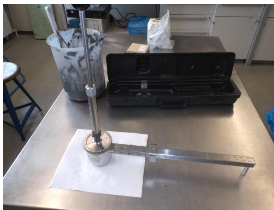
Abbildung 3-4: Einzelkomponenten der Druckspülungswaage (links), Druckbefüllung der Waage mit Suspension mittels Pumpe (rechts).
