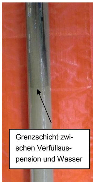
Abbildung 4-18: Vollständige Verdrängung des im „Bohrloch“ befindlichen Wassers
