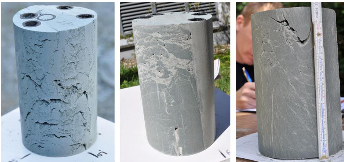
Abbildung 4-13: Beispielbilder von Rissstrukturen und Sackungen
