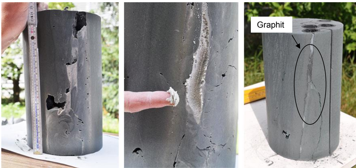
Abbildung 4-12: Beispielbilder von Entmischungen. Links und Mitte: Entmischung von quarzsandbasierten Verfüllbaustoffen. Rechts: In Aufstiegskanal angereichertes Graphit
