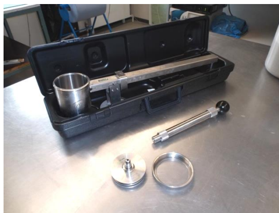
Abbildung 3-4: Einzelkomponenten der Druckspülungswaage (links), Druckbefüllung der Waage mit Suspension mittels Pumpe (rechts).
