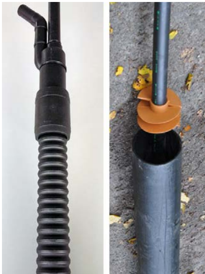
Abbildung 5-25: Unterschiedliche Varianten der EWS-Geometrie zur Erhöhung des konvektiven Wärmeübergangs. Links: Gewelltes Außenrohr; Rechts: Verwirbler zwischen Innen- und Außenrohr
