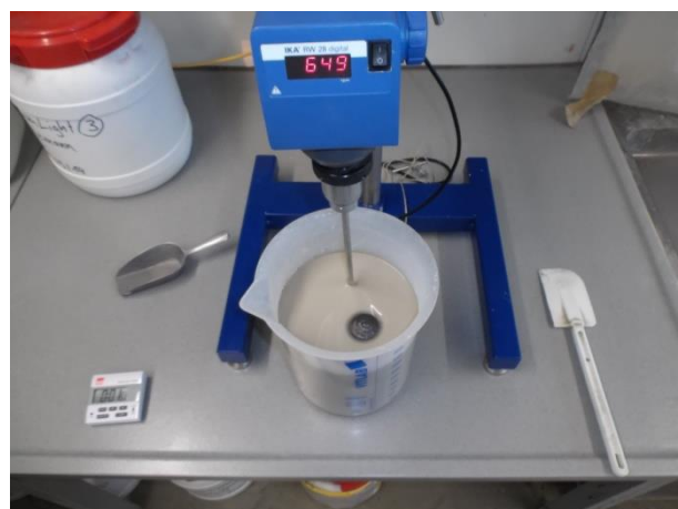
Abbildung 3-1: Labormischer mit Dissolverscheibe (links), Suspension während des Anmischvorgangs (rechts).
