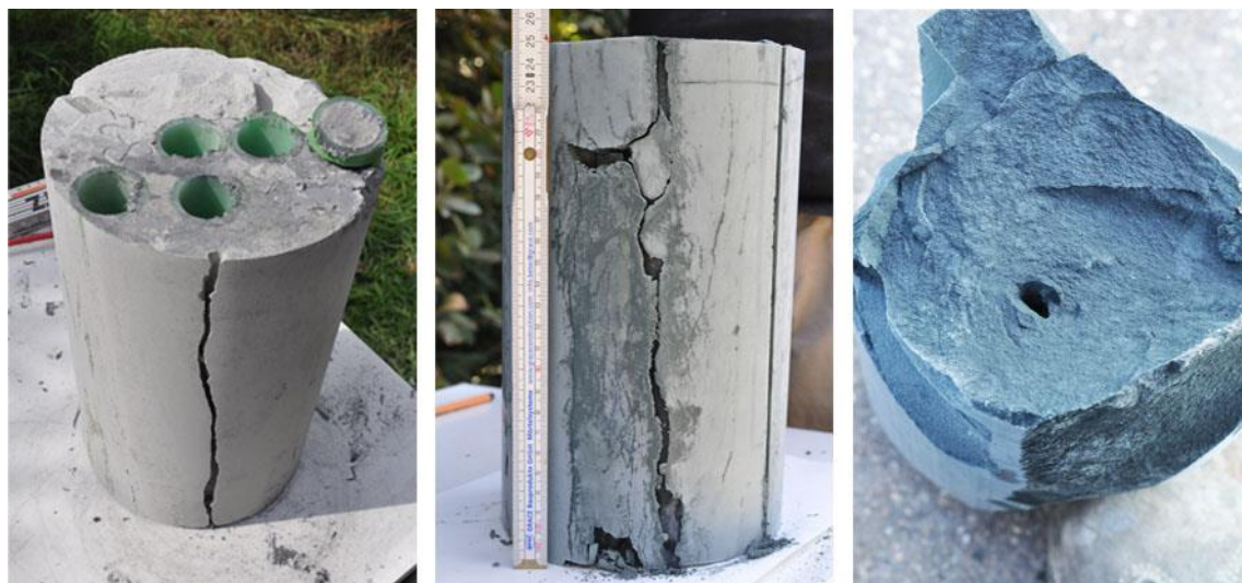
Abbildung 4-11: Unterschiedliche Varianten von Aufstiegskanalstrukturen. Links: An "Bohrlochwand" ohne Kontakt zum Sondenrohr. Mitte: Aufstiegskanal „an Bohrlochwand“ entlang Sondenrohr. Rechts: Aufstiegskanal im Zentrum von Versuchszylinder (ohne eingebauter EWS)
