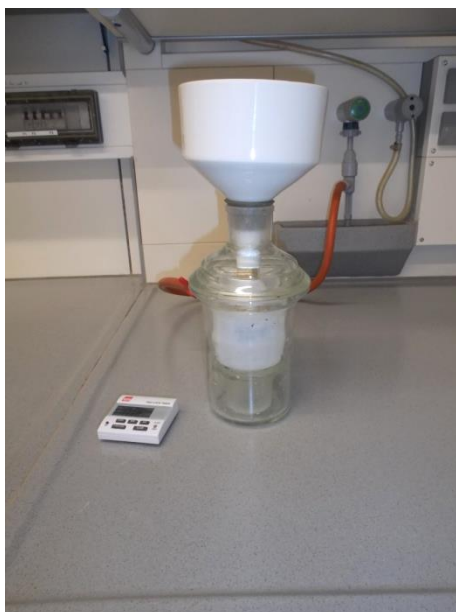
Abbildung 3-6: Filtrationseinheit mit Filternutsche, Exsikkator und Wasserstrahlpumpe (links), Filterpresse (rechts).
