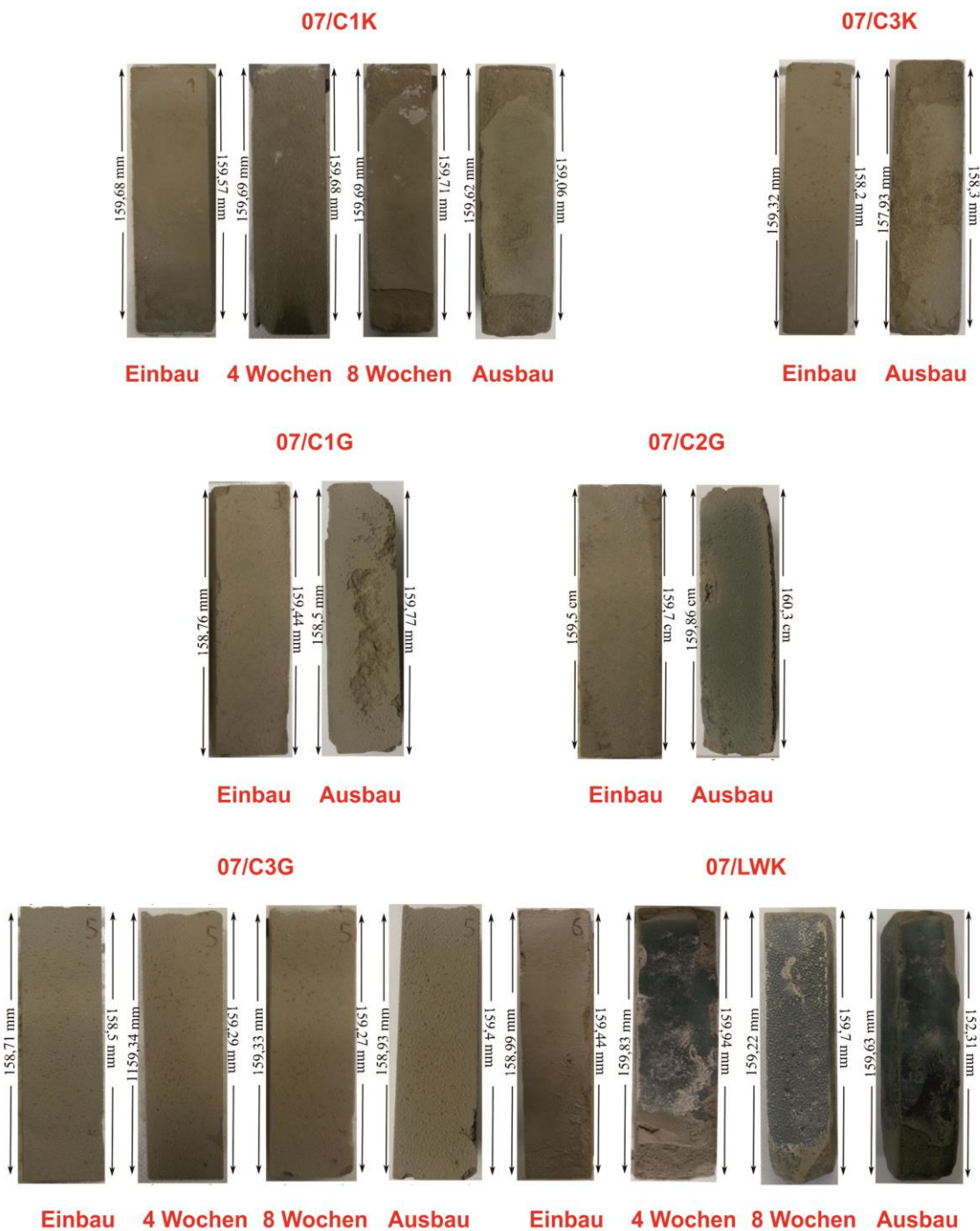
Abbildung 3-152: Bilder der Versuchsprismen des Hinterfüllbaustoffs 07 vor Versuchsbeginn und nach Versuchsende
