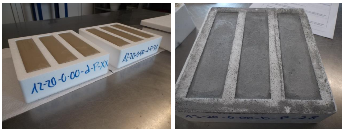
Abbildung 3-7: Frisch eingefüllte Suspension in Styroporformen (links), Prismen nach 28 Tagen Lagerung (rechts).
