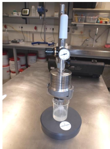
Abbildung 3-6: Filtrationseinheit mit Filternutsche, Exsikkator und Wasserstrahlpumpe (links), Filterpresse (rechts).
