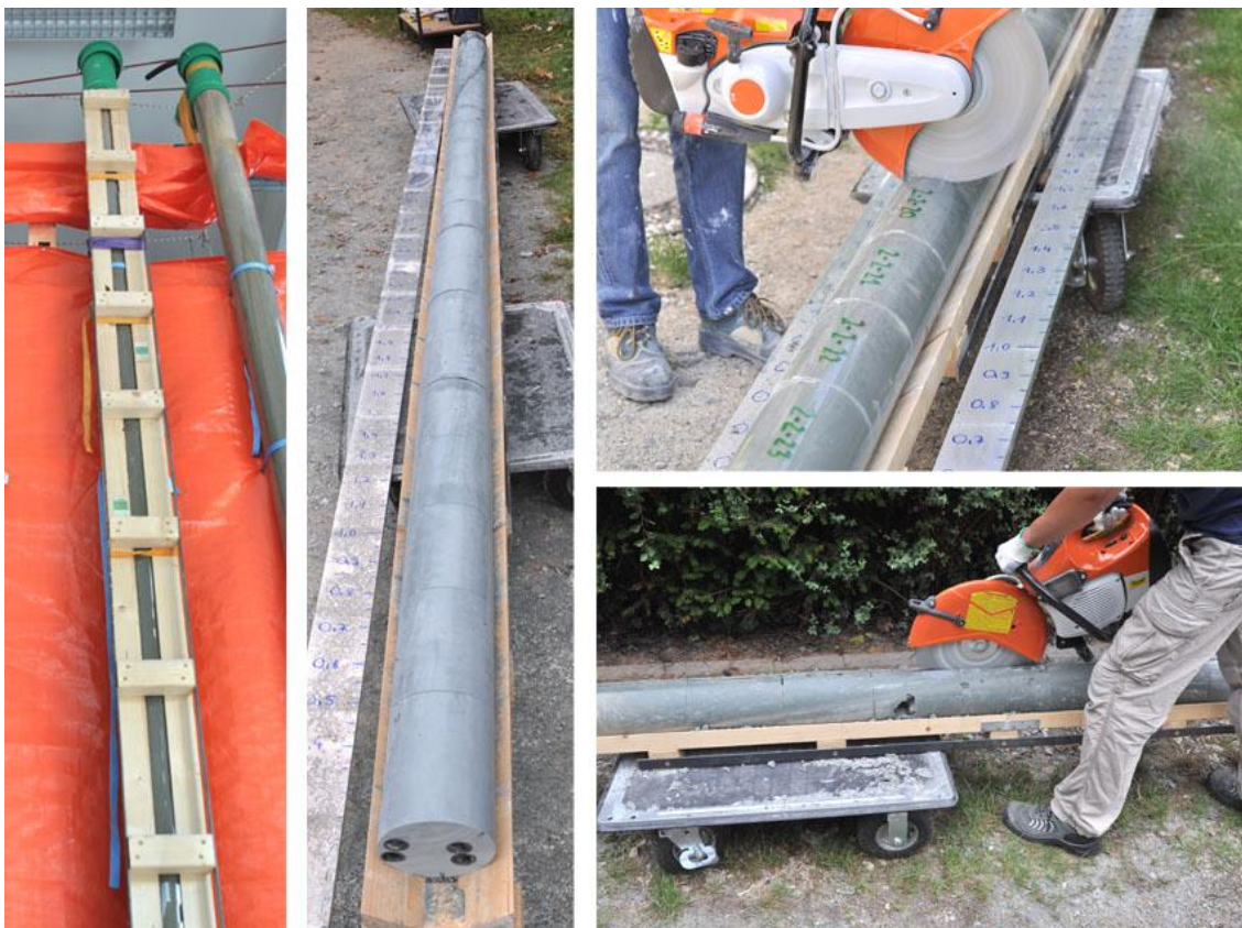
Abbildung 4-9: Exemplarischer Ablauf einer Analyse der Verfüllqualität nach einer Aushärtezeit von mindestens einer Woche
