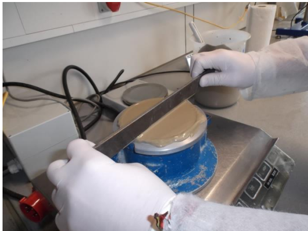
Abbildung 3-3: Befüllung des Dichtetopfes mit Suspension (links), Abziehen der Überschüssigen Suspension (rechts).
