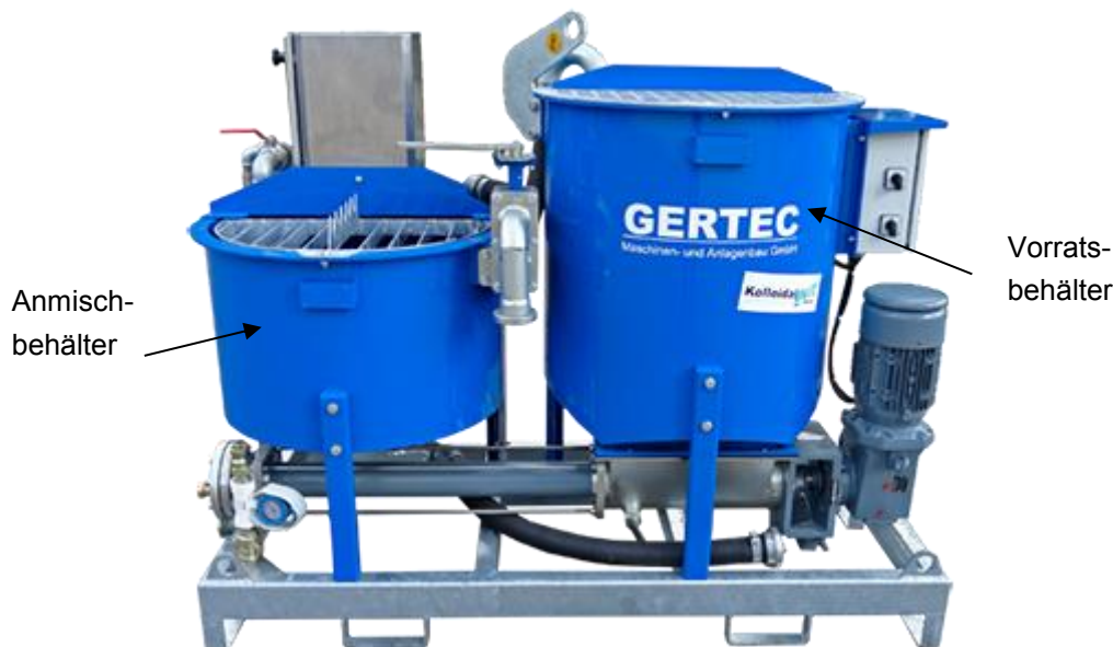
Abbildung 5-13: Bei den Technikums- und Realmaßstabsversuchen verwendete Niederdruck Misch- und Verfüllanlage IS-38-E. Bildquelle: Gertec Maschinen- und Anlagenbau GmbH
