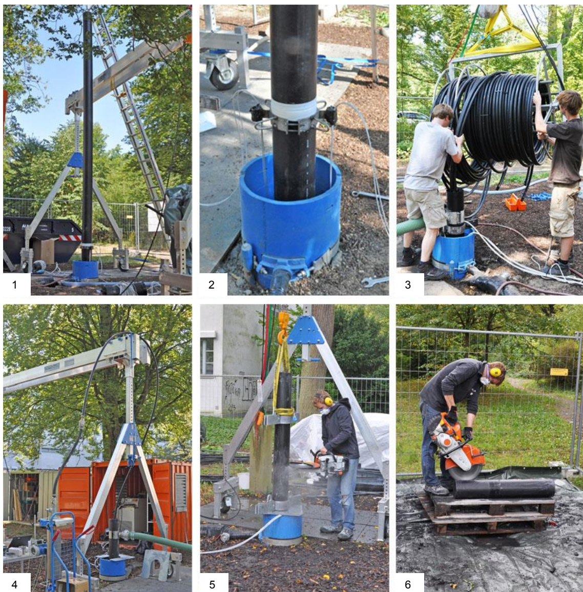
Abbildung 5-6: Ablauf eines Realmaßstabsversuches: 1: Einbau der 4,35 m langen PE-Innenrohre 2: Anbringung von Zentrierungen an jeder Gewindeverbindung der PE-Innenrohre und Befestigung der Pt100 Temperaturfühler; 3: Einbau der Sondenrohre (hier 2-U-EWS) mit einer am Portalkran aufgehängten Einbauhaspel; 4: Durchführung des Verfüllversuchs; 5 und 6: Abschnittsweiser Rückbau der Erdwärmesonde mit Analyse der Verfüllqualität
