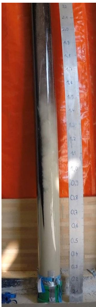
Abbildung 4-6: Darstellung eines Verfüllvorgangs einer Verfüllsuspension einer Verfüllsuspension
