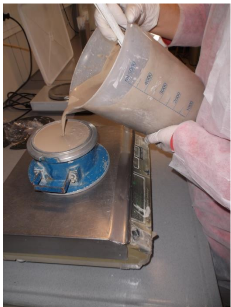
Abbildung 3-3: Befüllung des Dichtetopfes mit Suspension (links), Abziehen der Überschüssigen Suspension (rechts).
