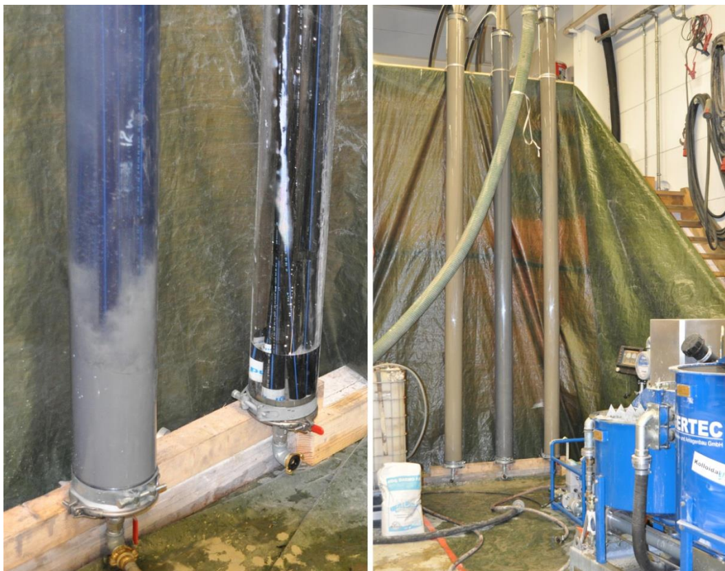
Abbildung 4-1: Verfüllvorgang des PVC-Rohrs während der Vorversuche (linkes Rohr im linken Bild) und Ansicht der drei in den Vorversuchen verfüllten PMMA-, PVC- und PC-Rohre (von links nach rechts im rechten Bild)
