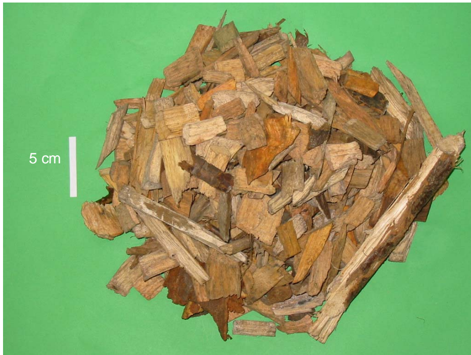
Abbildung 3.2: Grobfraktion einer Charge zerkleinert mit einem Trommelhacker mit Walzeneinzug. Das größte Brennstoffstück (unten rechts) misst 21,5 cm in der Länge.
