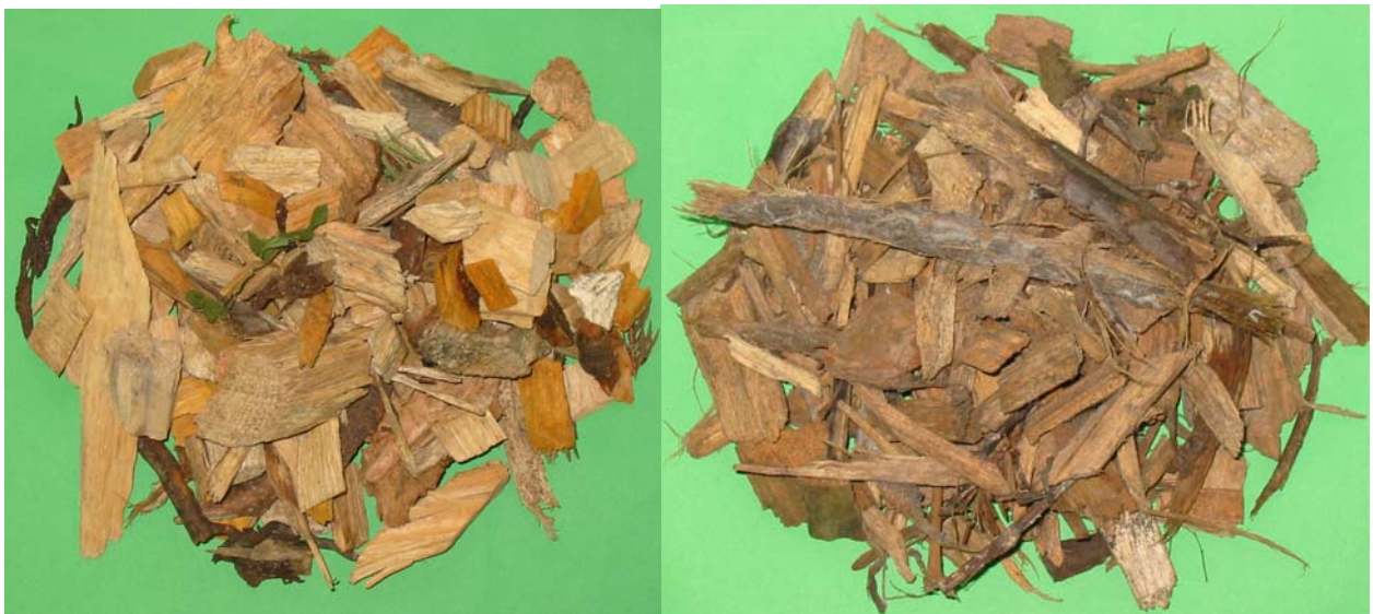
Abbildung 3.3: Vergleich von Holzhackschnitzeln aus einem Trommelhacker (links) mit Schredderholz (rechts)
