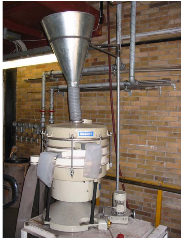
Abbildung 4.4: 5-stufiger Taumelsiebapparat zur Bestimmung der Korngrößenverteilung der untersuchten Brennstoffe
