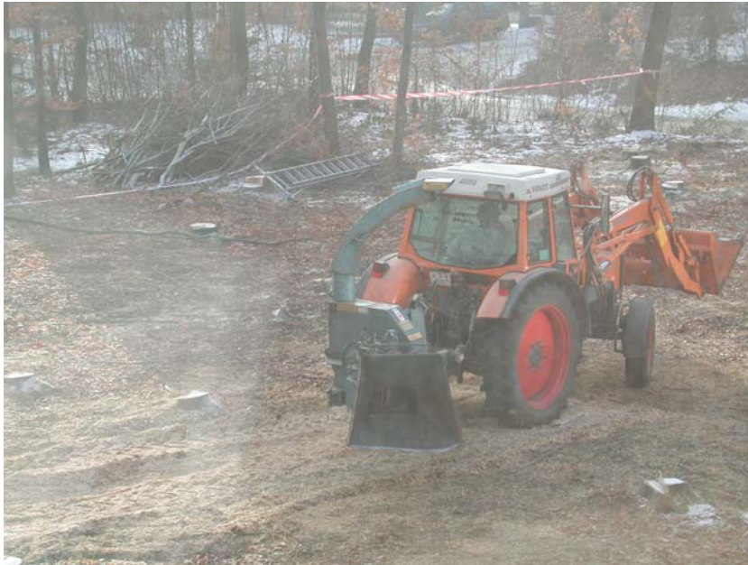
Abbildung 3.1: Scheibenradhacker an der Zapfwellen eines Schleppers (im Hintergrund Waldrestholz)
