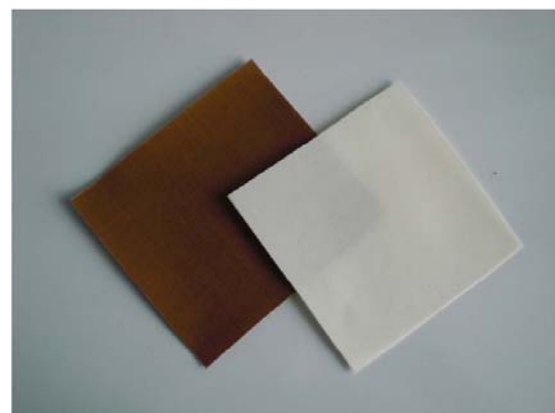
Abb. 9: In den Dialyseexperimenten verwendete Kationen- (links) und Anionenaustauschmembran (rechts).
