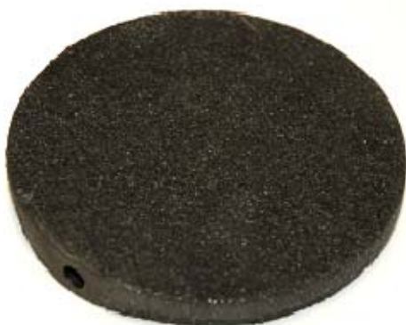
Abb. 8: In den Dialyseexperimenten verwendete Graphitelektroden (Anode, Kathode).
