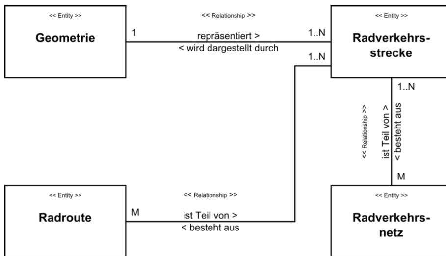
Abbildung 20: Alternatives ER-Diagramm zur lageunabhängigen Erfassung von Radverkehrsstrecken
