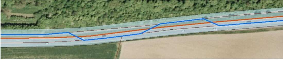
**Abbildung 33: Fehlerhaft angepasste Radverkehrsstrecke**
