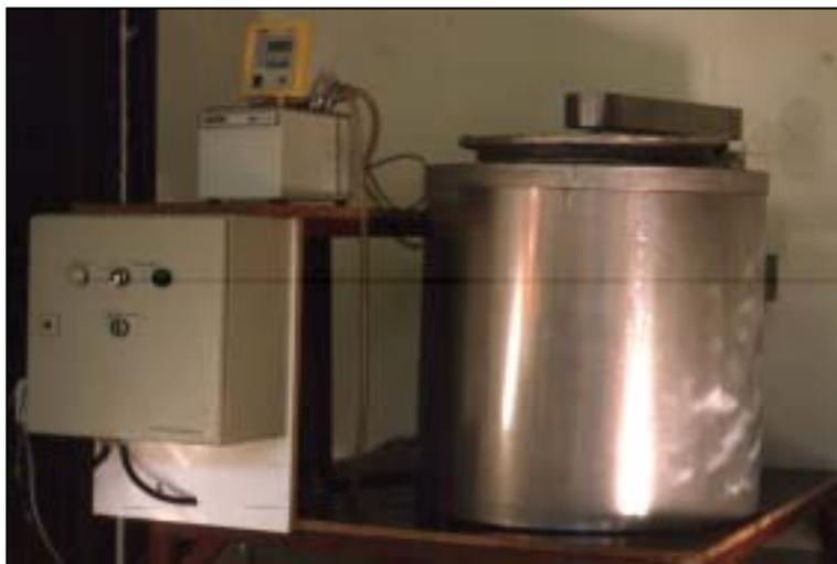
Abb. 3: Pasteurisierungsanlage im Modellmaßstab.
