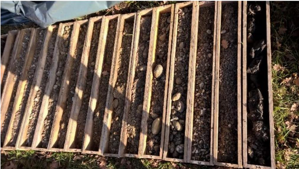
Abbildung 2.4: Material aus einer Kernbohrung im Untersuchungsgebiet
