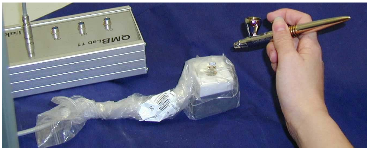
Abbildung 4: Beschichtung von Schwingquarzen mit der Air-Brush-Methode
