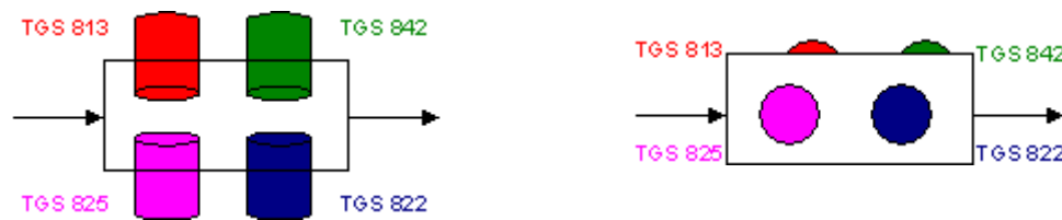
Abbildung 48: Anordnung der MOX-Sensoren
