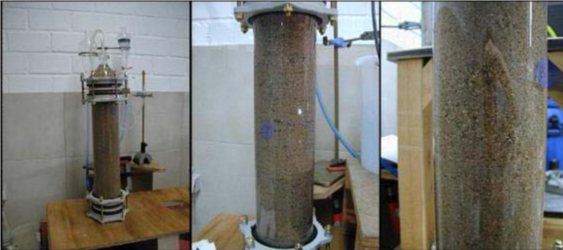
Abbildung 53: Säulenversuch zur Ermittlung der Sanierungseffizienz, links: unkontaminierte Säule, Mitte: kontaminierte Säule (Mineralöl, blau angefärbt), rechts: Tensidspülung
