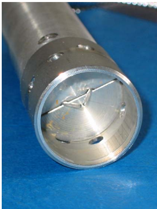
Abbildung 40: Anordnung der Fasern im Messkopf
