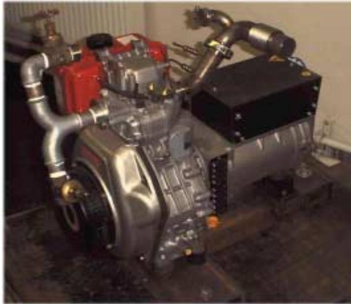
Abb. 2.2: Kleindieselmotor für die Versuche mit Dieselabgas.
