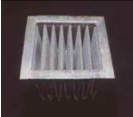
Abb. 4.7: Filter im Reaktorkopf aus metallischem Faservlies.
