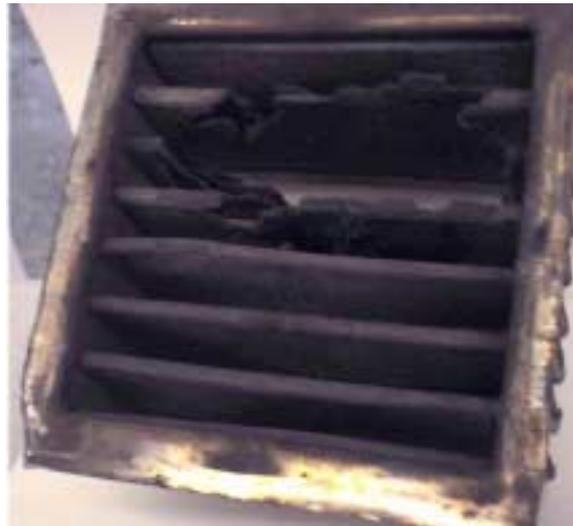
Abb. 9.4: Durch Übertemperatur zerstörter Metallfilter des Gegenstromreaktors.
