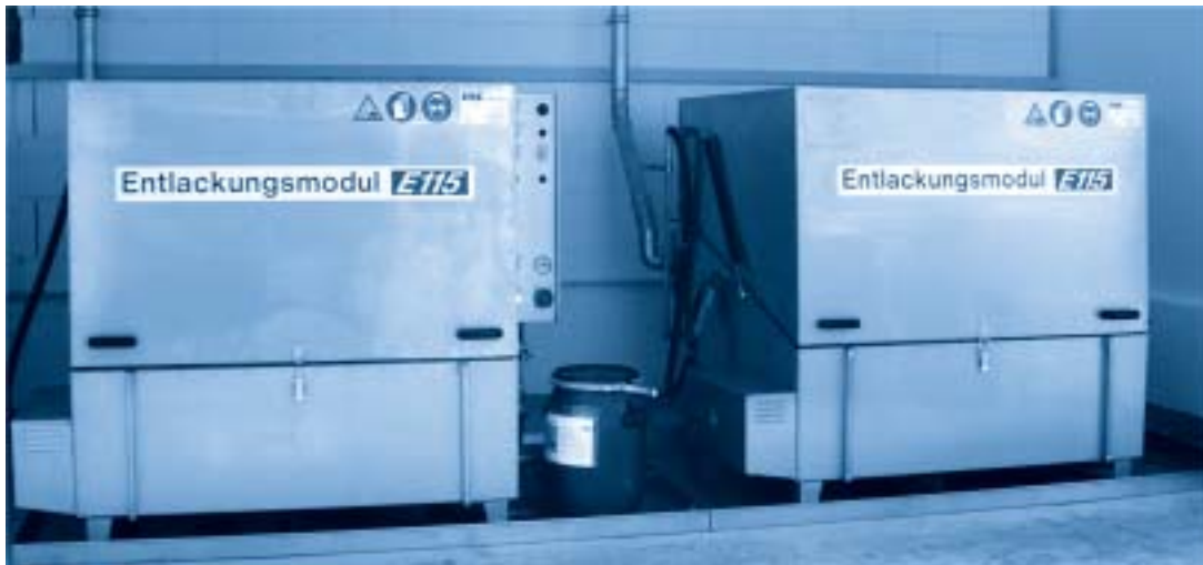
Abb. 4.4: Entlackungsanlage der Stoz Oberflächentechnik GmbH&Co. KG [Stoz 2000]
