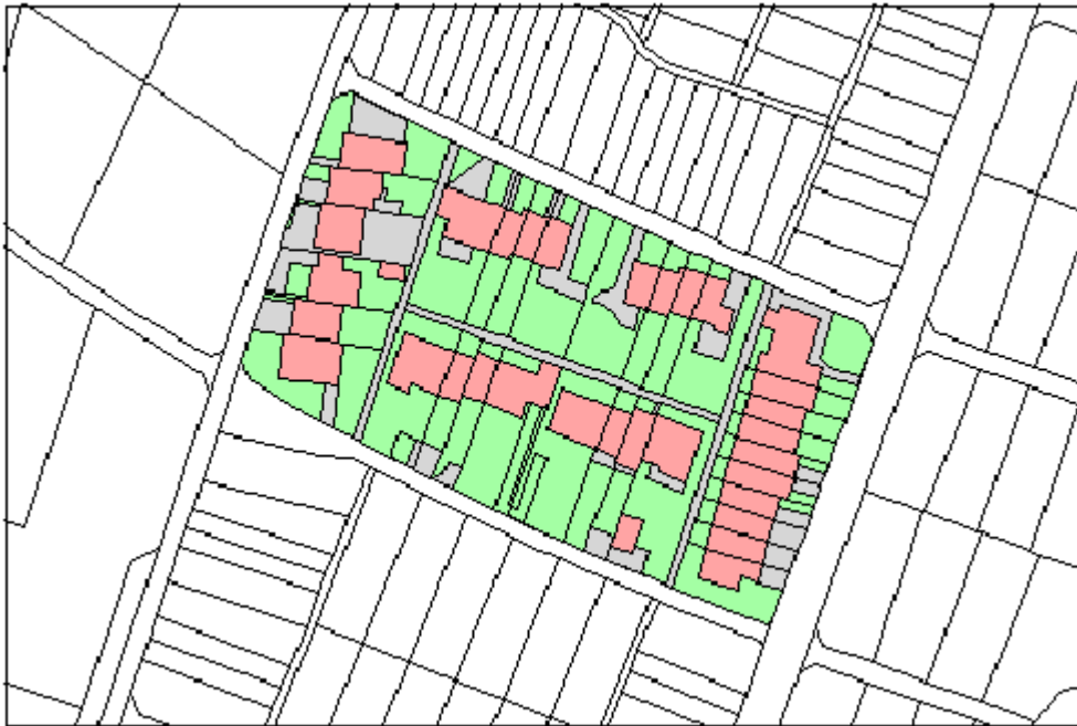
Abb. 3: Testfläche zur Unterstützung und Kontrolle der flächenhaften Schätzung des Versiegelungsgrades (Rot = Gebäude, Grau = versiegelte Freifläche, Grün = unversiegelte Freifläche)
