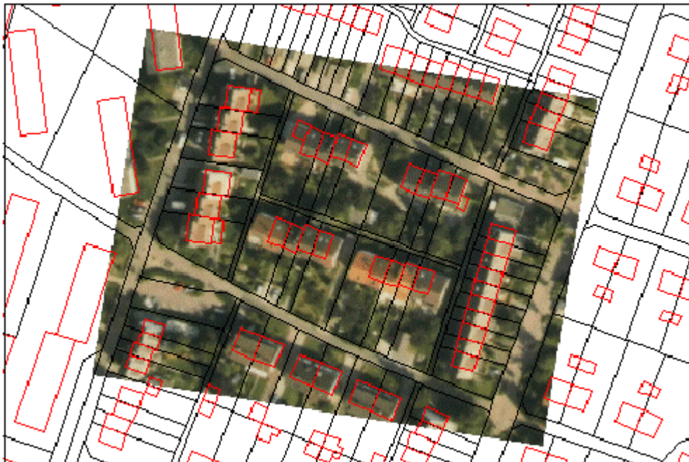
Abb. 2: Gescannter Farbluftbildausschnitt, überlagert mit der Automatischen Liegenschaftskarte (ALK) als Datengrundlage zur Digitalisierung einer Testfläche (Einzel- und Reihenhausbebauung)
