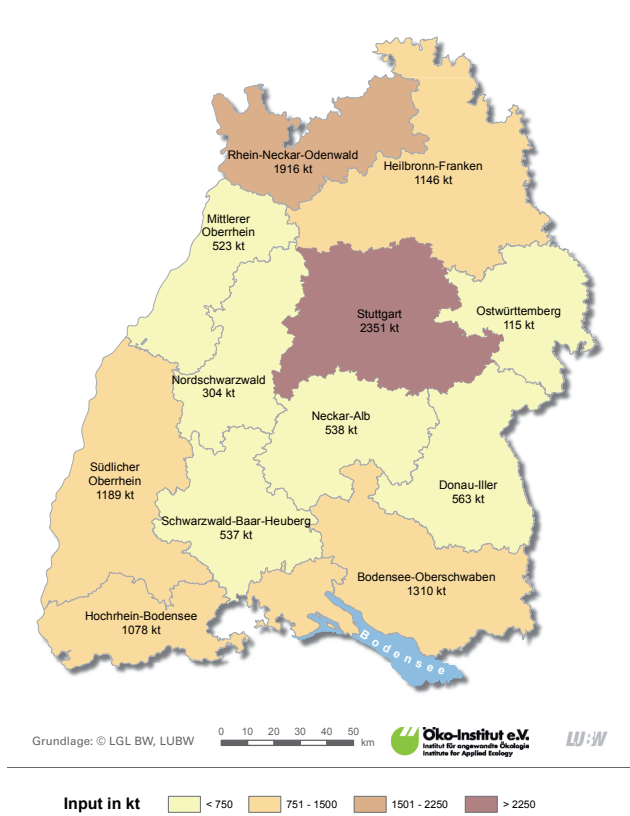
Abb. 2-2: Bau- und Abbruchabfälle: Regionale Verteilung des Inputstroms in Behandlungsanlagen; Quelle: Statistisches Landesamt Baden-Württemberg, eigene Darstellung, Einteilung der Klassen für Inputmaterial ist frei gewählt
