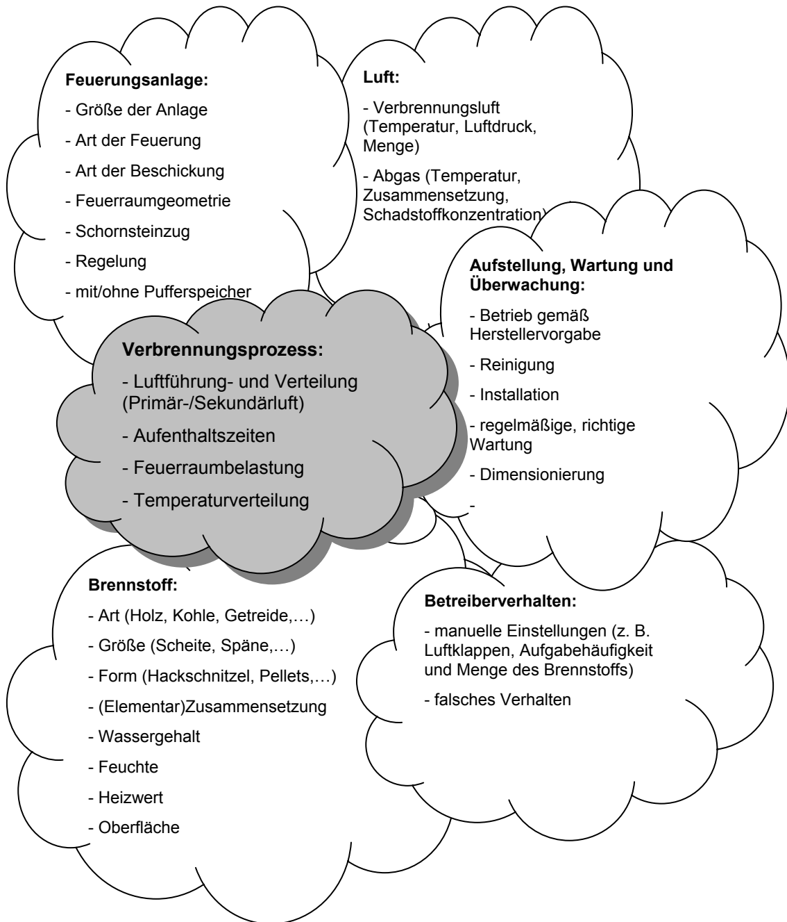
Bild 2.1: Einflüsse auf die Verbrennung von Festbrennstoffen
