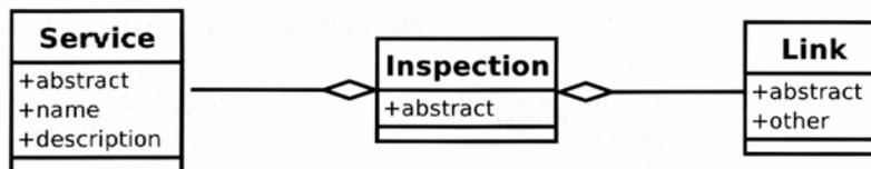
Abbildung 43: WS-Inspection-Datenmodell
