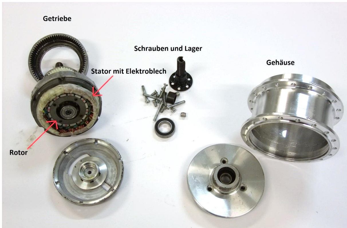
Abbildung 5-4: Separierte Bauteile eines Nabenantriebes
