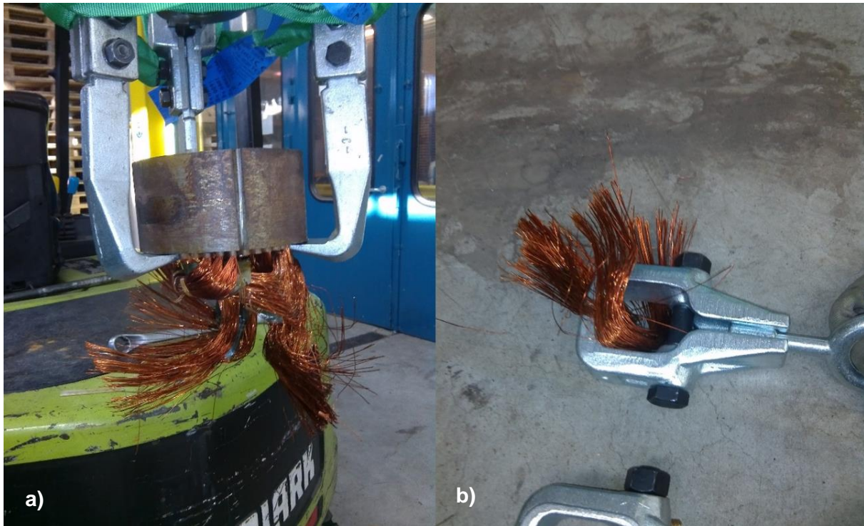
Abbildung 5-10: Ergebnis des Zugversuches: a) Stator mit verbliebenen Kupfersträngen, b) Zugklemme mit herausgezogenen Kupfersträngen
