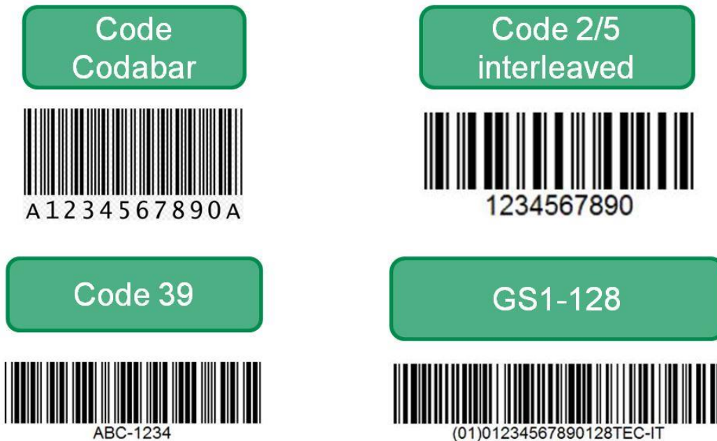
Abbildung 4-3: Beispielhafte Darstellung verschiedener 1D-Barcodes
