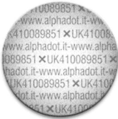
Abbildung 4-7: Beispiel eines Microdots. Aus [Alpha Dot]
