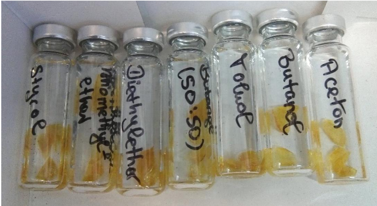
Abbildung 5-14: Proben nach dem Lösemittelversuch mit organischen Lösemitteln bei Zimmertemperatur
