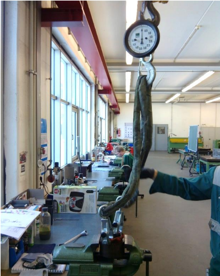
Abbildung 5-3: Versuchsaufbau der Zugversuche
