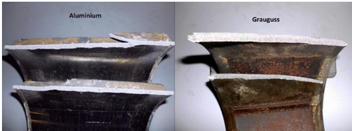
Abbildung 5-2: Bruchkanten eines Aluminium- und eines Graugussgehäuses nach Öffnung durch Hammerschlag
