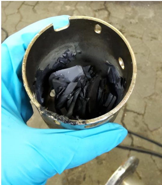
Abbildung 5-24: Stator des Motors der Motorlüftung Modell 2 (VW) mit beschädigten Magneten
