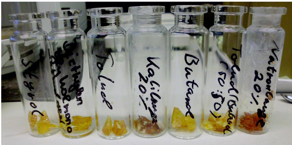
Abbildung 5-16: Getrocknete Tränklackproben nach dem Lösemittelversuch bei 60 °C
