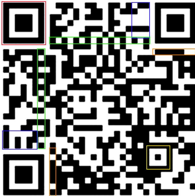
Abbildung 4-8: Für das Auslesen der enthaltenen Information wichtige Elemente eines QR-Codes (im Bild farbig markiert) [Hengstbach 2011]
