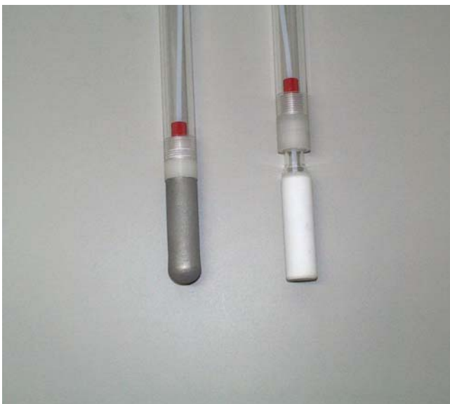
Saugkerzen aus V4A-Edelstahl (links) und Borsilikatglas (rechts)
