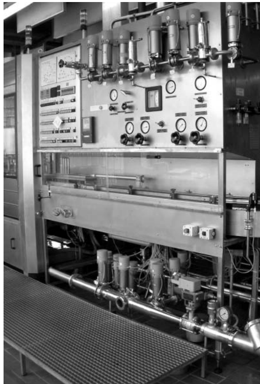
Abb. 6.20: Bedienblock der Flaschenabfüllanlage (60.000 Flaschen je Stunde)
