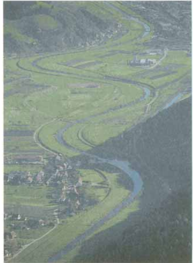
Abb. 101 Kerbsohlental im Mittellauf der Kinzig (Ortenaukreis). Linienführung sehr stark verändert, natürlicherweise leicht gekrümmt und zum Teil verzweigt. Auenbereich (Deiche, Gräben)
