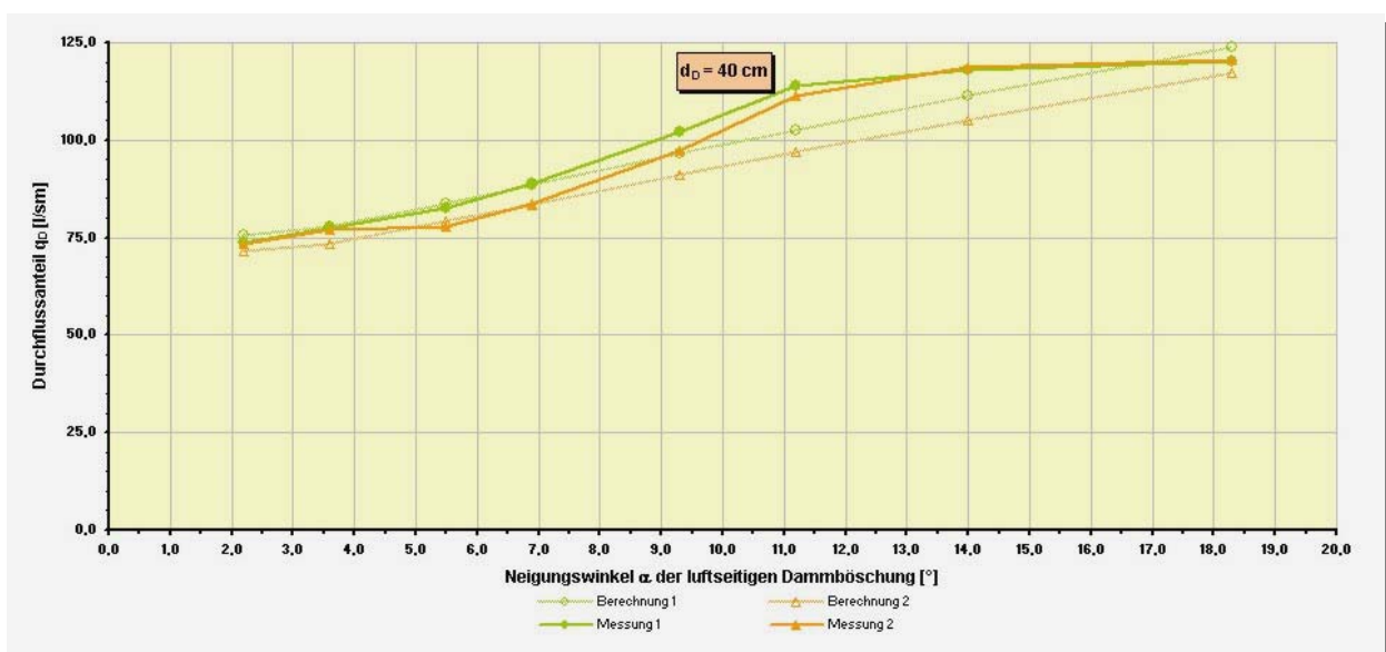
Abb. 10: Berechnete und gemessene Durchflussanteile q_D bei d_D = 40 cm mit Ansatz des Korrekturfaktors \zeta
