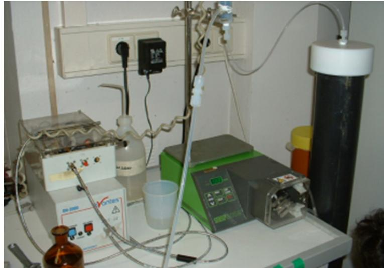
**Abbildung 4-17:** Aufbau des Retardationsversuchs mit gekühlter Säule
