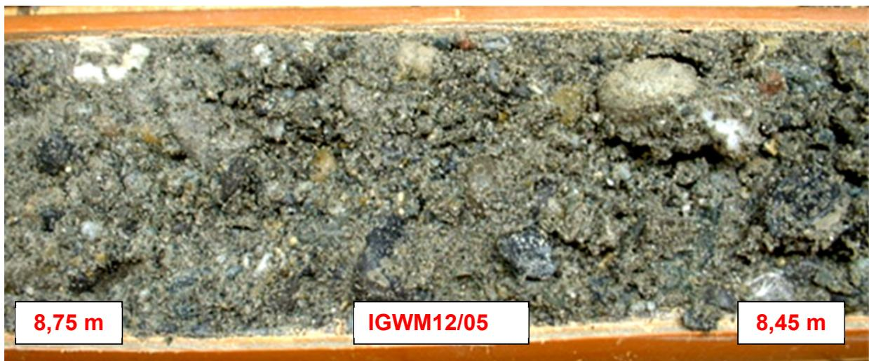
**Abbildung 4-16:** Probenmaterial im aufgetrennten Liner der Bohrung IGWM12/05
