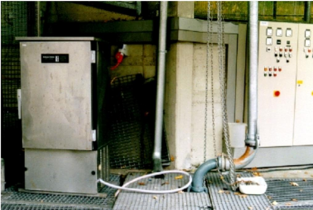
Versuchspumpe und Probenehmer bei Durchführung der Versuche mit direkter Entnahme des Mischwassers
