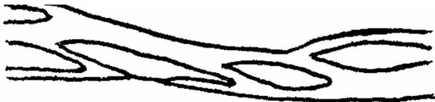
Inseln verursachen in einem Gewässer Veränderungen im Durchflussverhalten und in der Geschwindigkeitsverteilung (z.B. Verzögerung, Verzweigung, Beschleunigung). Damit verbunden ist eine Erzeugung von Sekundärströmungen an den Seiten der Inseln sowie Kármán'sche Wirbelstraßen im Unterwasser.
