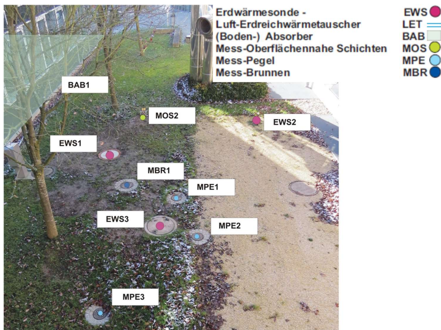
Abbildung 37: Messstellen für Untergrundtemperaturen an der HBC (LET im Foto nicht abgebildet).
