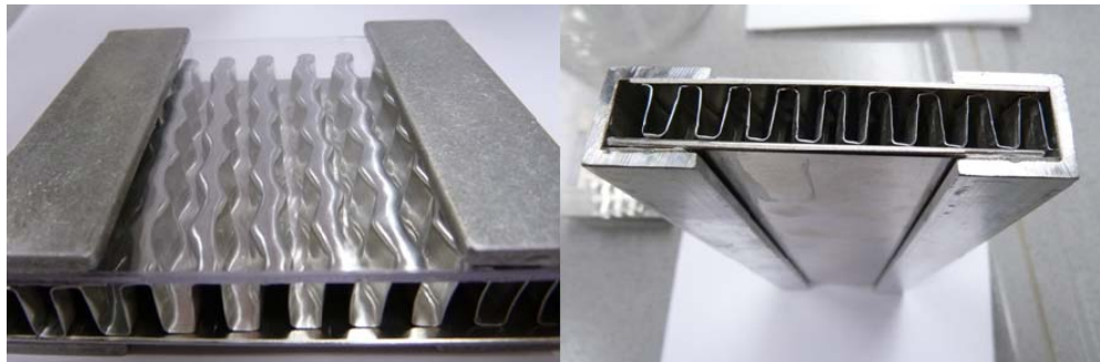
Abbildung 22: Lamellenkanal einlagig für Beschichtungstests
