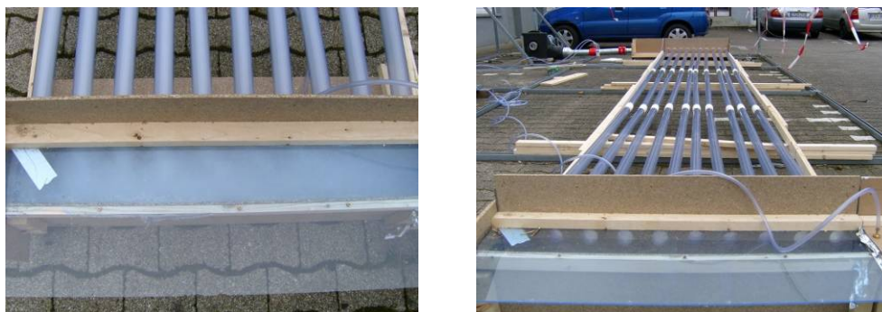
Abbildung 47 Durchströmungstests mit transparenten Prototyp
