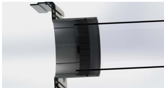
Abbildung 17: Durch Andrücken an Header eingerasteter Mitnehmer in Verschraubung
