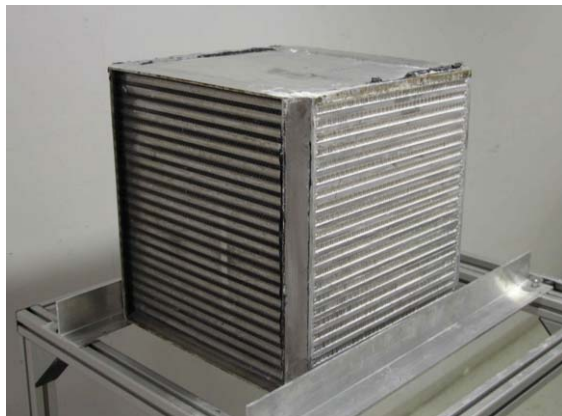
Abbildung 38: Beschichteter Haugg-WÜ nach Trocknen der Beschichtung
