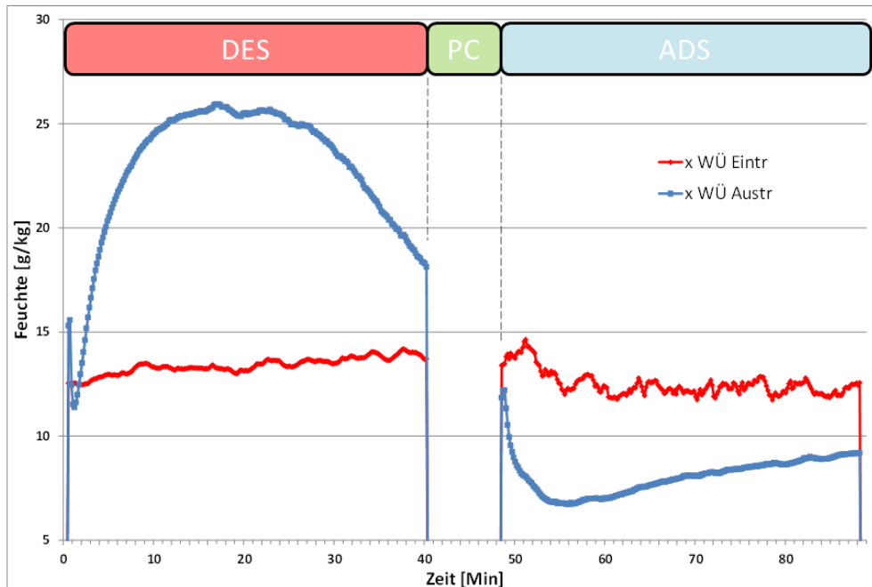
Abbildung 52: Luftfeuchten am WÜ Ein- und Austritt während eines Messzyklus
