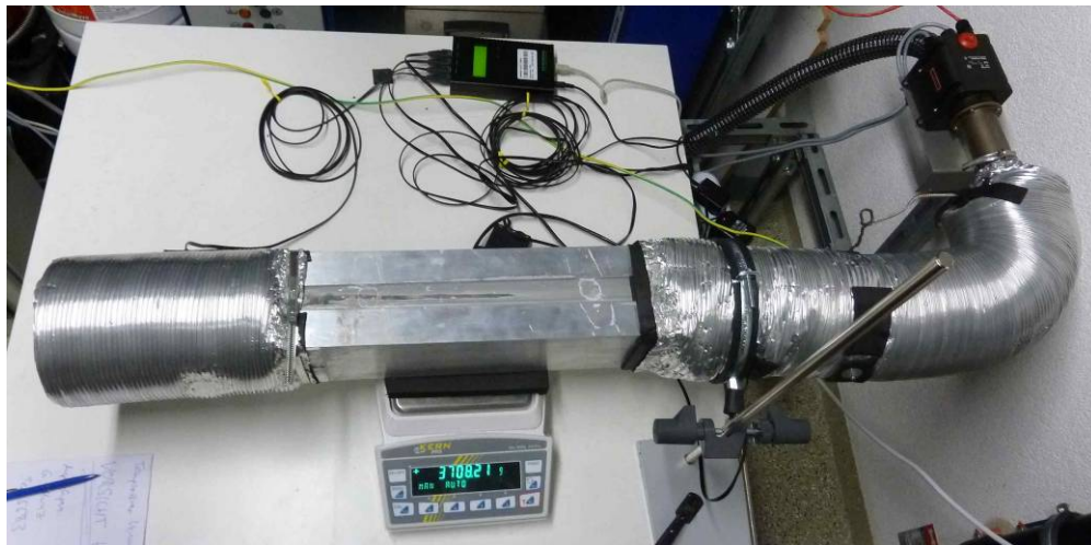
Abbildung 45: Messaufbau mit Waage, Dummy-1, Heizelement und Datenerfassung zur Aufzeichnung der Temperatur und Feuchte
