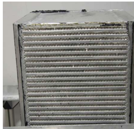
Abbildung 38: Beschichteter Haugg-WÜ nach Trocknen der Beschichtung
