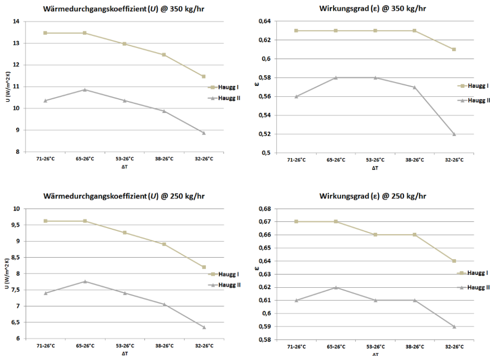
Abbildung 40: Darstellung der Werte des Wärmedurchgangskoeffizienten sowie des Wirkungsgrades
