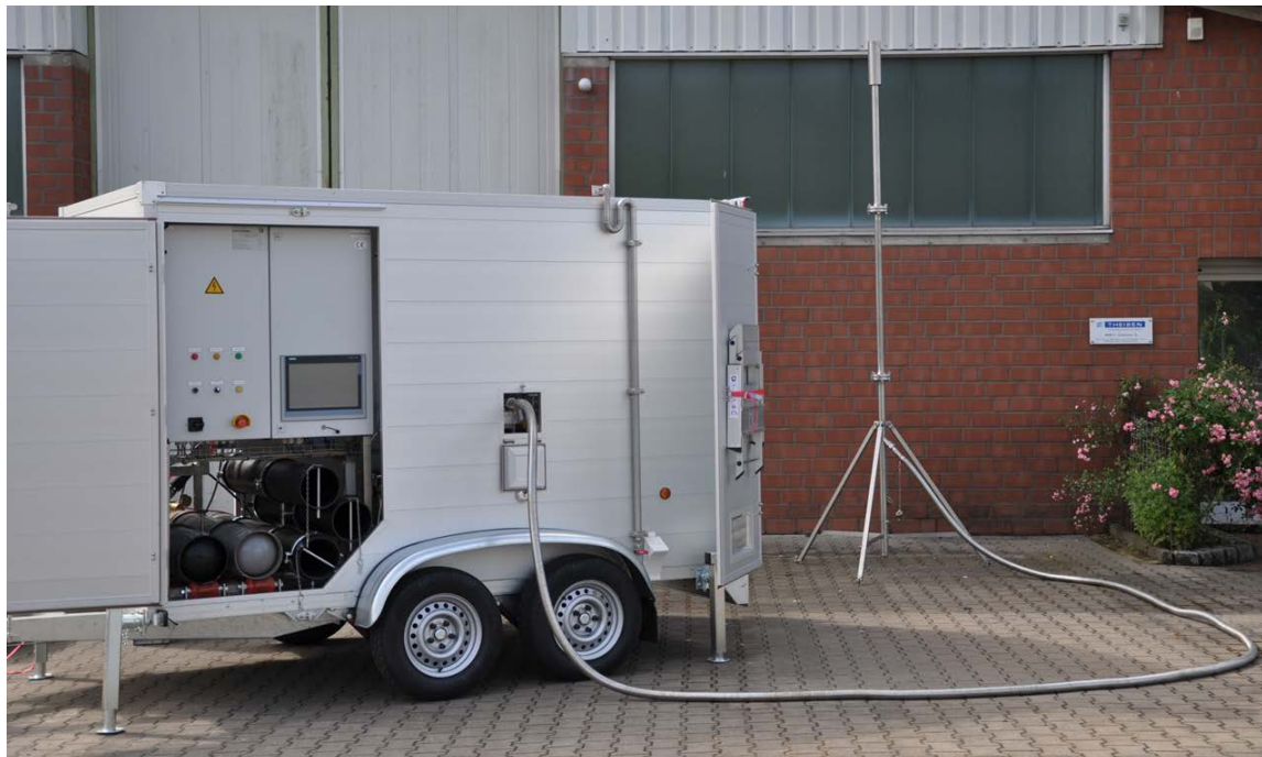
Abbildung 4: Ansicht FSTM mit angeschlossenem Ablasskamin für Wiederholmessungen
