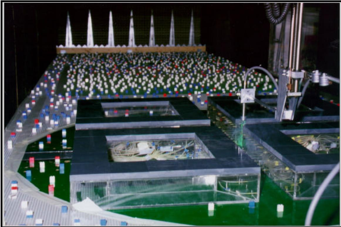
Abb. 9.3: Blick in den Windkanal mit dem eingebauten Modell der Straßenkreuzung. Zu sehen ist der Versuchsaufbau bei den Messungen mit der Optiksonde im Windkanal (Bezeichnung kleine Optik) und die Anlaufstrecke mit den Rauhelementen und den Wirbelgeneratoren im Hintergrund.
