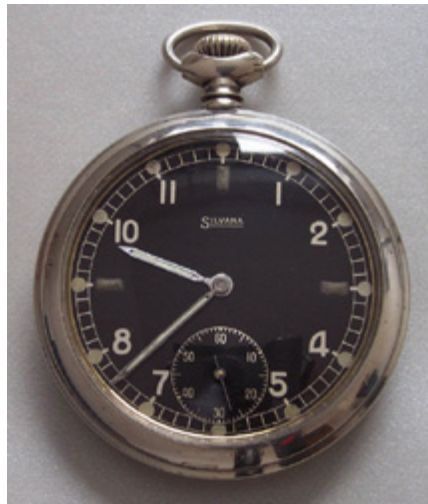
Abbildung 2.5.3: Kurskreisel ca. 80 kBq Ra-226 (links), Taschenuhr 3,4 kBq Ra-226 (Mitte), Original ERKO Radium Trink- und Badekurapparat ca. 1 MBq Ra-226 (rechts)
