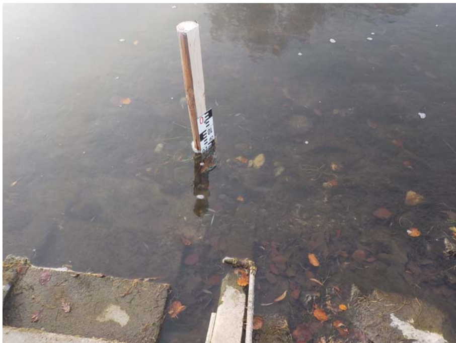
Bild 1: Hilfspegel am Pegel Donaueschingen - Donau (Foto: Benno Schulz)
