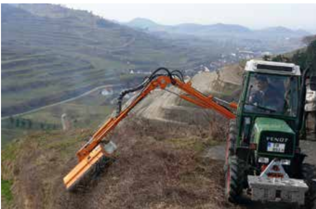
Abbildung 4: Bei der Böschungspflege können zur Arbeitserleichterung auch Überstockmulcher eingesetzt werden.
