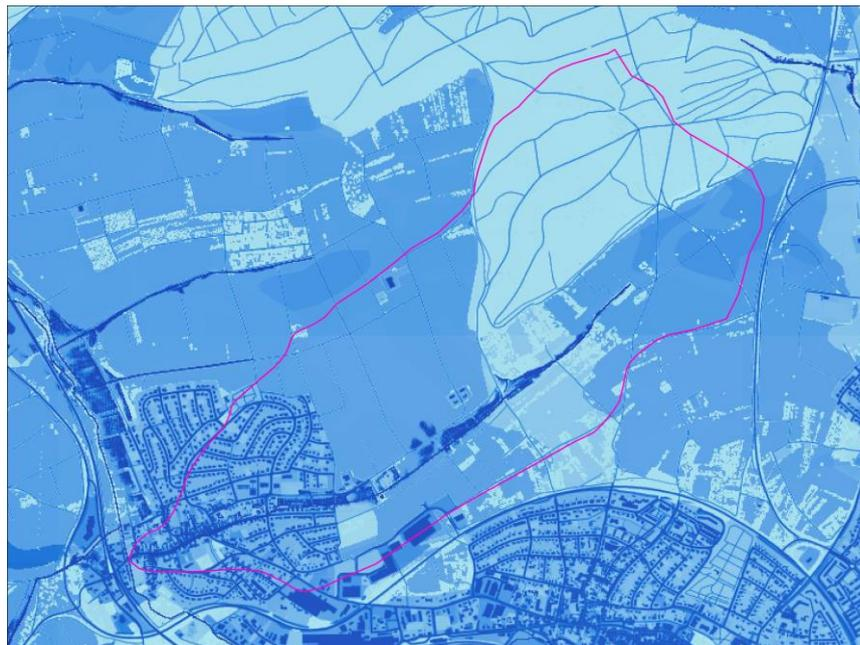
**Abbildung 8.** Oberflächenabflusskennwerte zu dem außergewöhnlichen Szenario im Basisgebiet Riedgraben.
