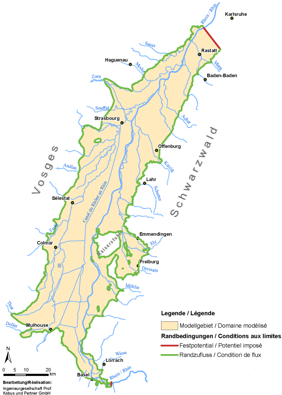
Abbildung 7.2.1: Horizontale Ausdehnung des Grundwassermodells und Randbedingungen an den Modellrändern. Figure 7.2.1: Limites horizontales du modèle hydrogéologique et conditions aux limites.
