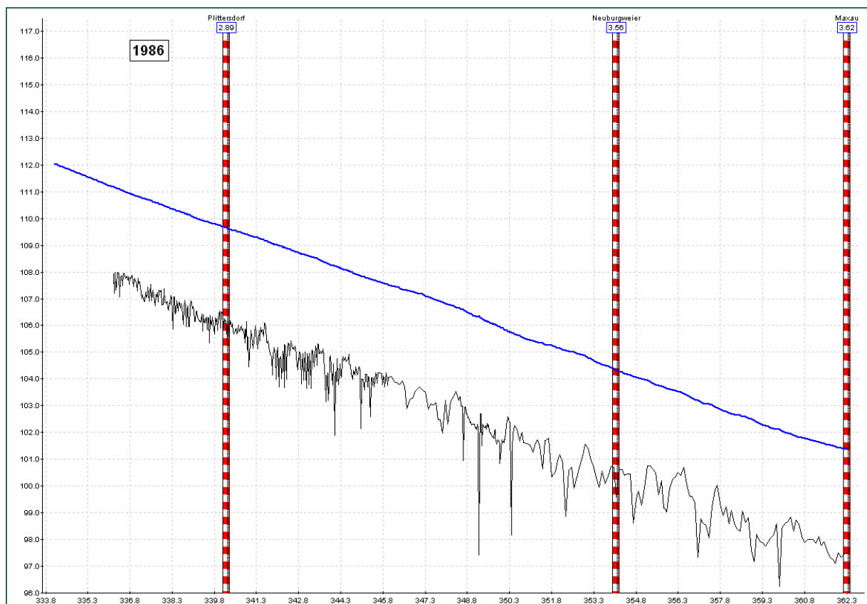
Abb. 4.5.1: Berechneter Wasserspiegel im Teilabschnitt 9 Iffezheim - Maxau (Rh-km 334,100 - 362,300) am 20.10.1986, Talweg, Pegel Plittersdorf, Neuburgweier und Maxau
