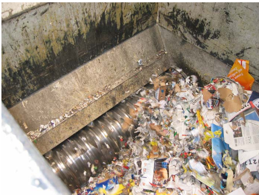
Abb. 2: Die schnelllaufende Schneidwalze in Aktion
