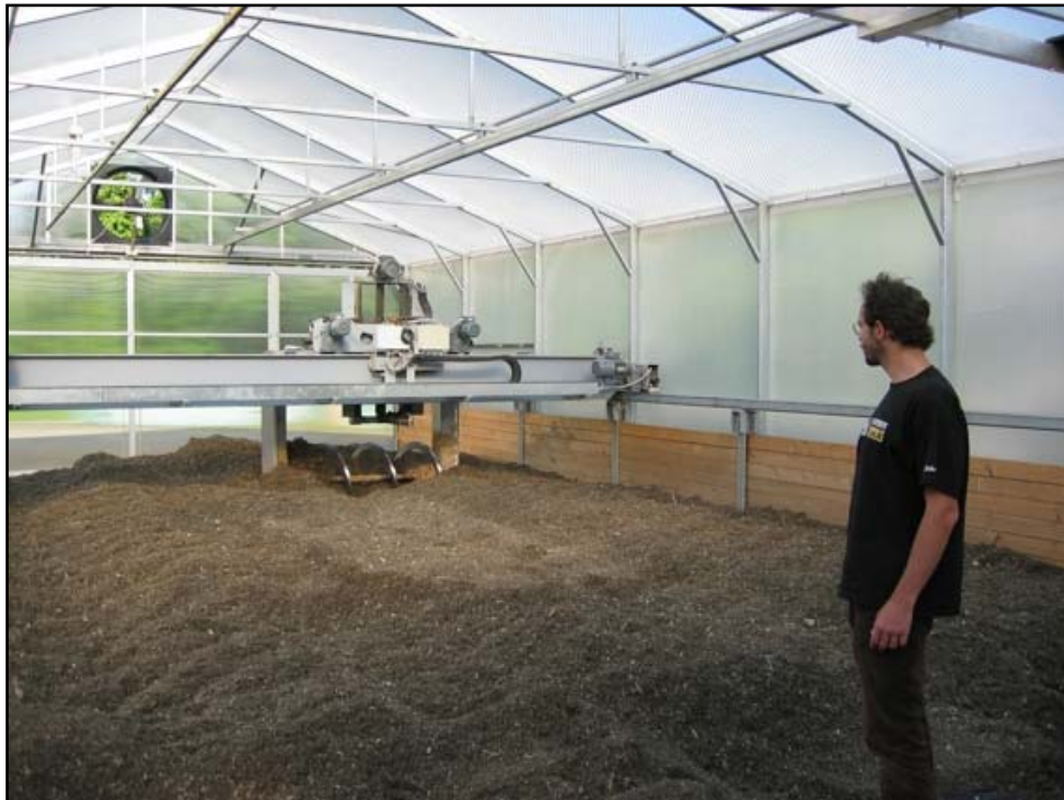
Abb. 14: Mix-Trocknung mit dem Solartrockner der Universität Hohenheim
