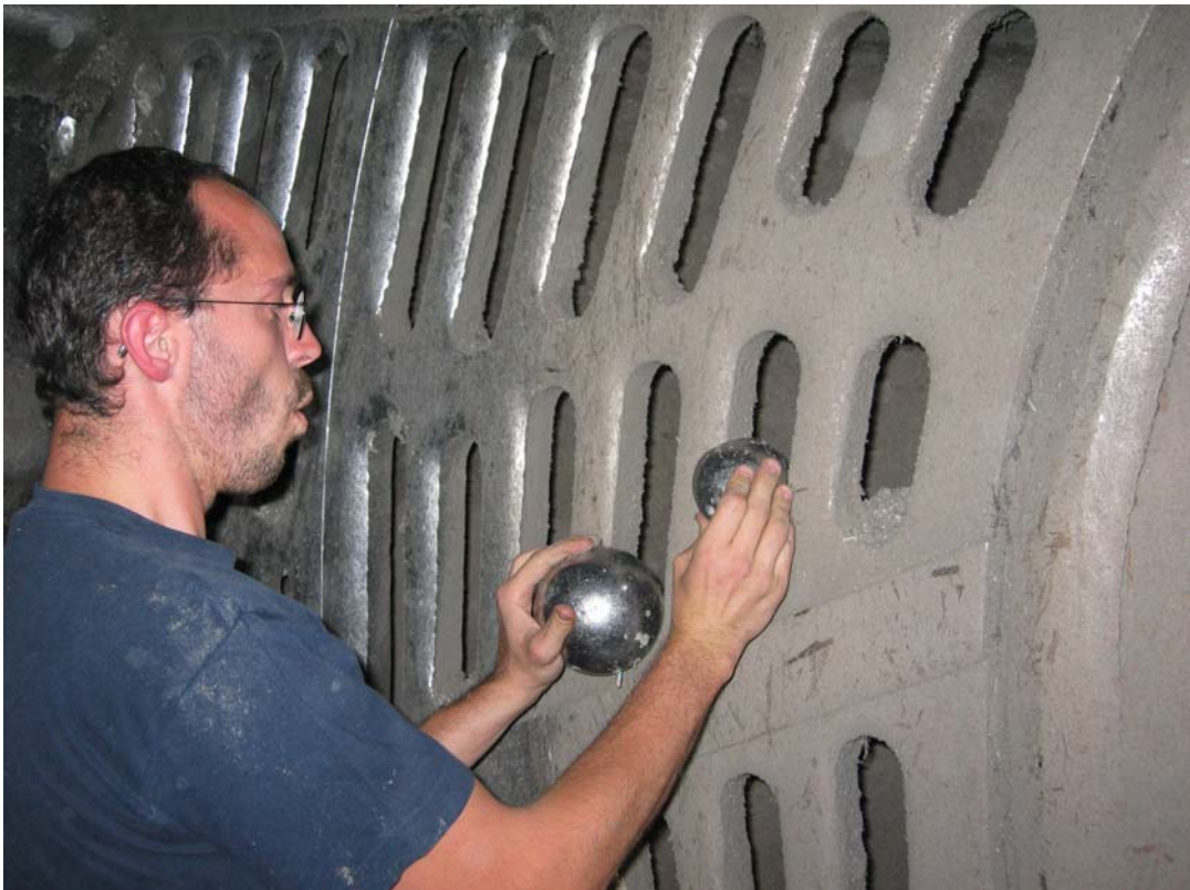
Abb. 3: 80 mm Schlitze im Innern der Kugelmühle für abgenutzte Kugeln
