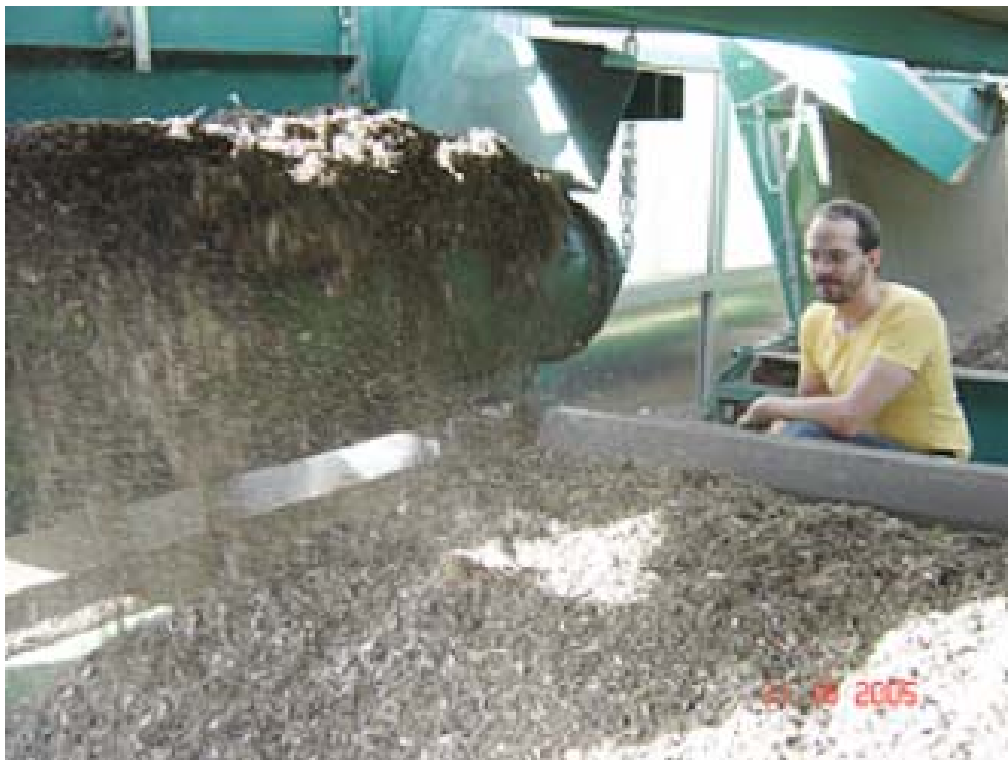
Abb. 7: Aufbringung des Mix auf das Förderband (Etage 1)
