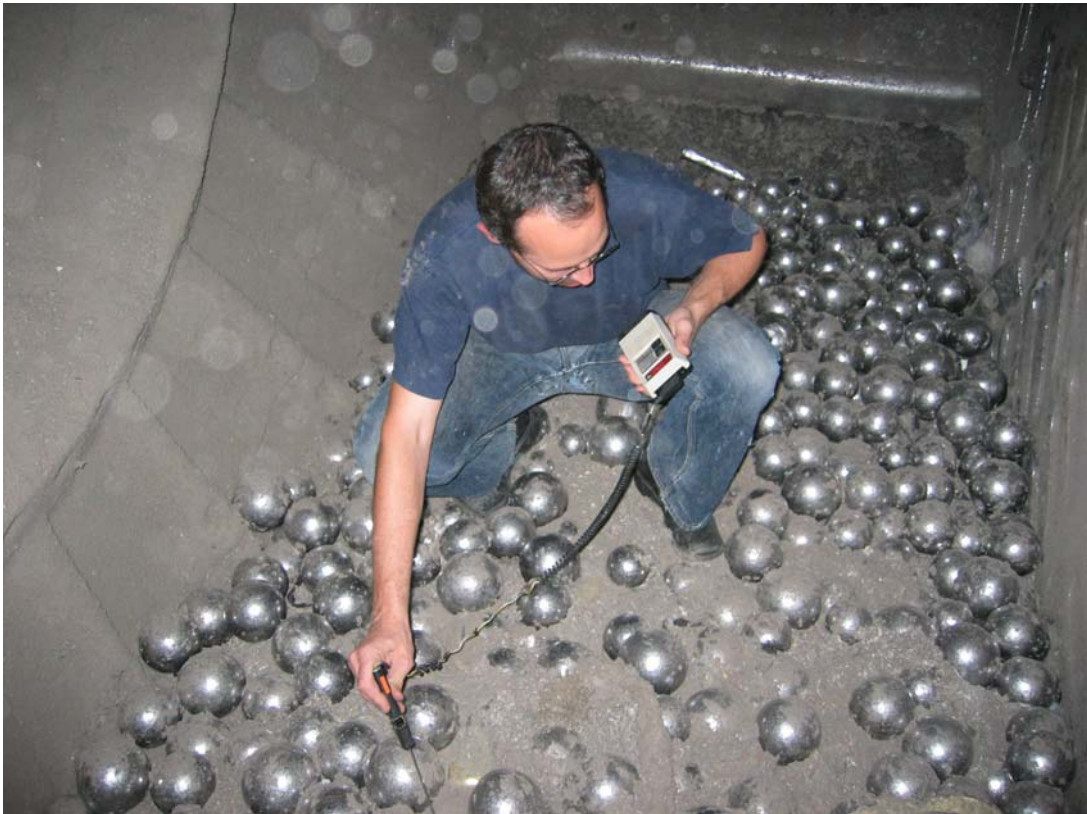
Abb. 4: Stahlkugeln und zerkleinerter Müll in der Kugelmühle
