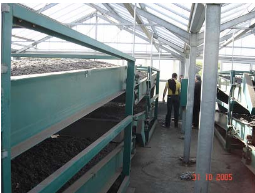
Abb. 8: Beschickte Förderband-Etagen des Solartrockners
