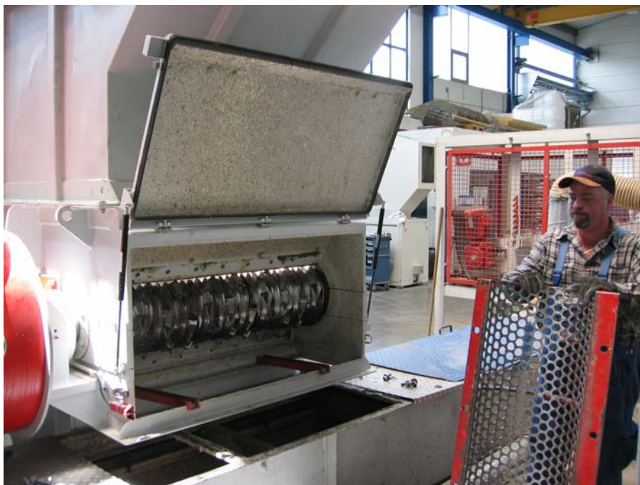
Abb. 1: Einsetzen des 30 mm Siebs in die Vecoplan-Schneidwalzenmühle
