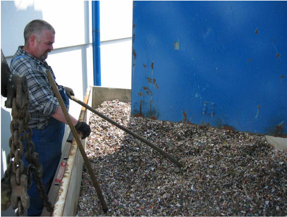
Abb. 3: Zerkleinerter feuchter Mix am Austrag der Vecoplan Schneidwalzenmühle
