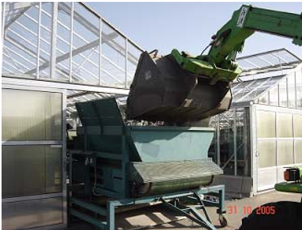
Abb. 6: Eintrag des feuchten Mix in die Vorlage des Solartrockners
