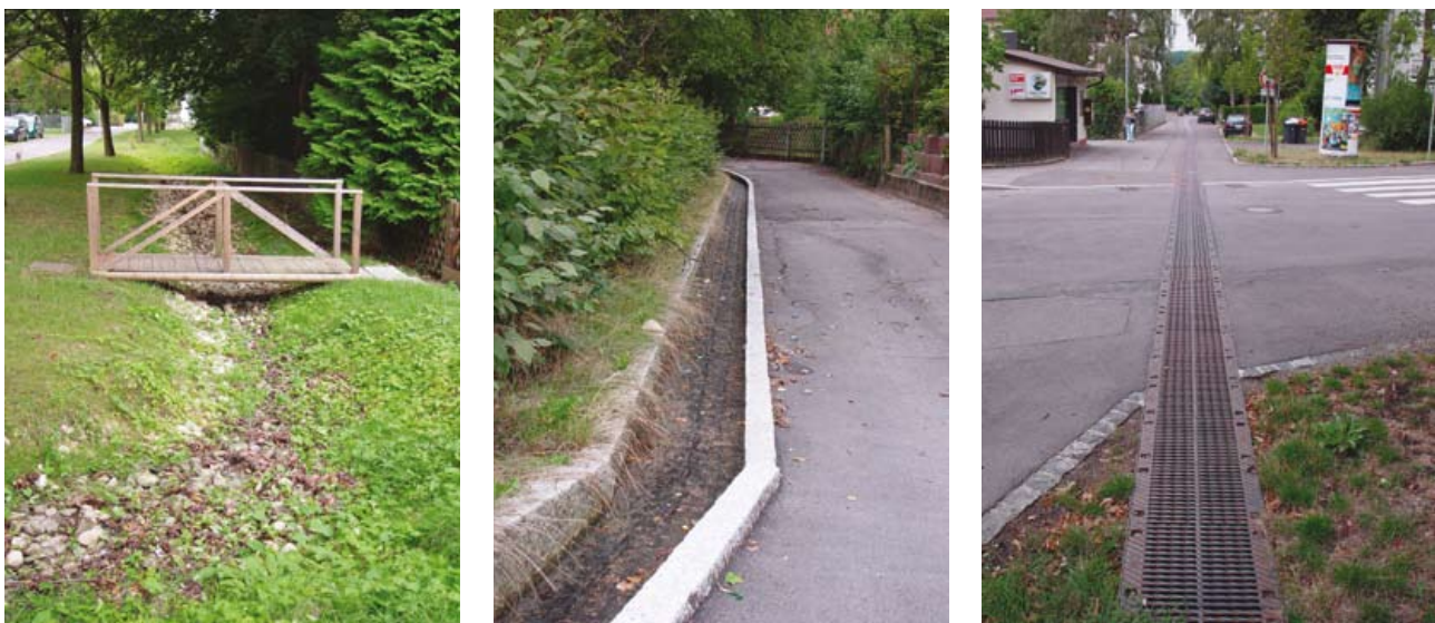
Abb. 80: Verschiedene Formen der oberirdischen Ableitung
